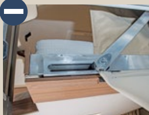
Freiliegende Hubbett-Mechanik mit scharfkantiger Holzleiste.
