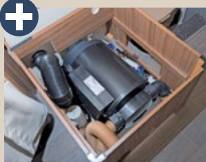
Heizung Truma Combi 4 und Frostschutzventil gut erreichbar.
