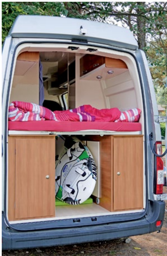
Gut gemacht: Der Mittelteil des Bettes lässt sich wegklappen. Dadurch vergrößert sich das Ladevolumen der durchladbaren Heckgarage, die dann sogar Surfbretter und auch Fahrräder aufnehmen kann.
