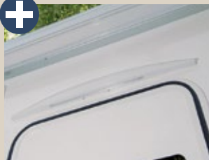
Aufbautür mit ausreichend breiter Regenrinne und LED-Leuchte.
