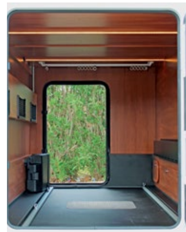
Die gut ausgeleuchtete Garage bietet stets zwei Türen. Über die Klappen in der Vorderwand sind die Wassertanks gut zugänglich. Der Abwasserhahn öffnet elektrisch.
