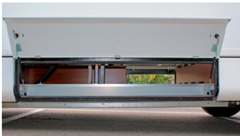
Hinter der breiten, von Gasdruckdämpfern gehaltenen Außenklappe ist der Doppelboden sehr gut zugänglich. Wer hiermit und der Heckgarage nicht klarkommt, braucht einen Lkw.
