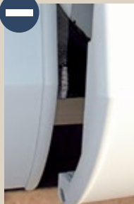
Kein Einzelfall: Die Schürze der Aufbautür scheuert am Bodenbrett des Einstiegs.
