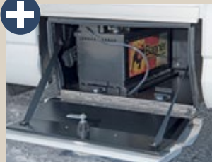
Praktisches Batteriefach mit Halterung für zweiten Bord-Akku.
