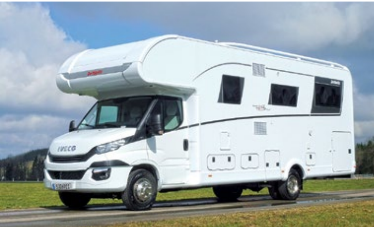
Groß geraten: Der neue Alpa rollt auf einem Iveco Daily mit Zwillingsbereifung. Im beheizten Doppelboden sind die Versorgungstanks untergebracht.
