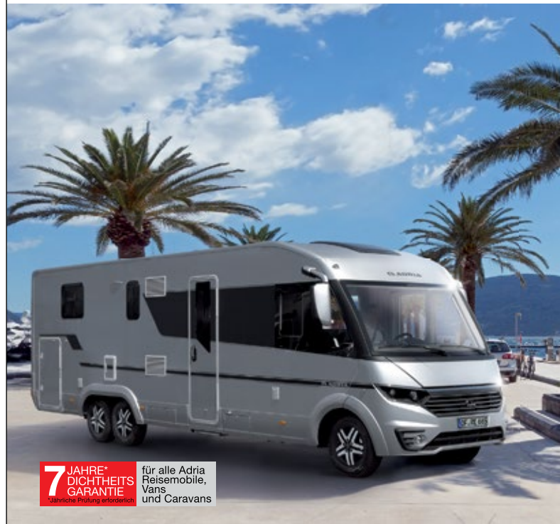
Groß geraten: Der neue Alpa rollt auf einem Iveco Daily mit Zwillingsbereifung. Im beheizten Doppelboden sind die Versorgungstanks untergebracht.
