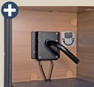
**Sehr gut erreichbarer und einfach zu bedienender Hebel für den Ablasshahn des Abwassertanks.**
