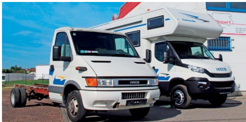
*Bild oben: Nachdem die Kabine vom alten Chassis getrennt ist, halten Stützen sie in Position. Das neue Chassis fährt darunter, die Kabine wird anschließend langsam abgesetzt. Bild unten: vorher und nachher – links das alte 50C13, rechts das neue 70C18-Chassis.*
