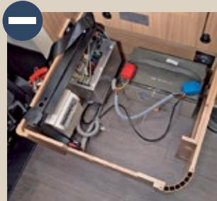
**Kabel der Elektrik in der Truhe des Seitensitzes unzureichend gegen Beschädigung geschützt.**
