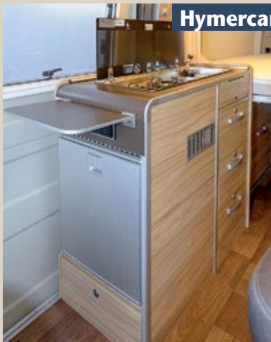
Einfallreich: Da das Heckbett längs im Yosemite steht, ist der Einbau eines Kühlschranks hinter der Küche nicht möglich. Deshalb baut ihn Hymer in der Flanke des Küchenmöbels ein.
