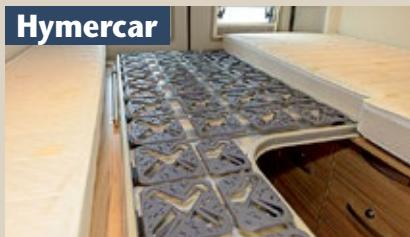
Der wegklappbare Mittelteil des Heckbetts wird mit einem Kunststoffteller-Lattenrost bestückt, die Gasabsperrhähne befinden sich leicht bedienbar in Hüfthöhe an der Küchenfront.
