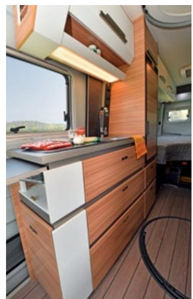
**Die komplett mit Schubladen ausgestattete Küche gewinnt durch das Auslagern des Kompressorkühlschranks an Stauraum.**
