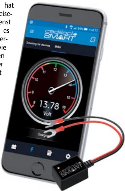
**Minimaler Montageaufwand: Cadillock Smart wird einfach an die Pole der Batterie geklemmt.**
