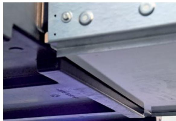
**Ein Blick unter den glatten Boden des neuen Leichtbau-Chassis. Hinten setzt Hymer eine Wanne als Boden für die sehr tragfähige Heckgarage an.**
