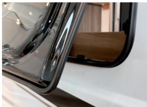
Carapro heißt jetzt „Der clevere Kantenschutz“. Der Name ist Programm: Ein aus hochwertigem Silikon gefertigtes Stoßschutzprofil soll am aufgestellten Wohnmobilfenster für Schutz vor Kopfverletzungen sorgen. Der Kantenschutz eignet sich für alle vorgehängten Fenster und kann – je nach Größe des Fensters – individuell zugeschnitten werden. „Der clevere Kantenschutz“ verkauft das Profil im Onlineshop zu einem Preis von 7,90 Euro pro Meter.
