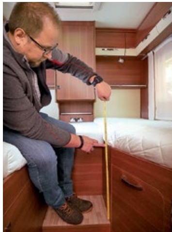
Im Cruiser Comfort T 732 (rechts) erleichtern die um 20 Zentimeter abgesenkten Betten den Einstieg, im Cruiser Passion 643 G sind sie normal hoch.
