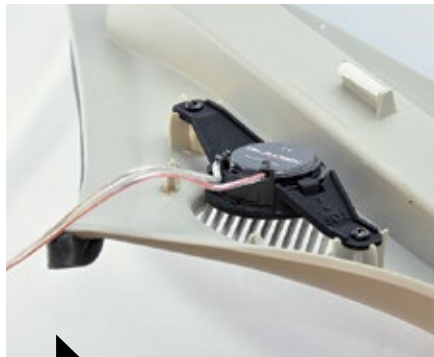
2 Schön zu sehen: Die speziell für die Remis-Verkleidung geformten Haltearme des Gladden-Hochtöners. Effekt: perfekter Abstrahlwinkel.
