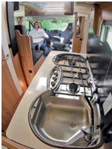
Der Küchenblock im Cruiser Passion 643 G steht auf der Beifahrerseite und ist sehr geräumig. Dreiflammherd und Edelstahlspüle deckt eine geteilte, dunkle Glasscheibe ab. Ein Heki erhellt die Halbdinette, welche die Frontsitze komplettieren.
