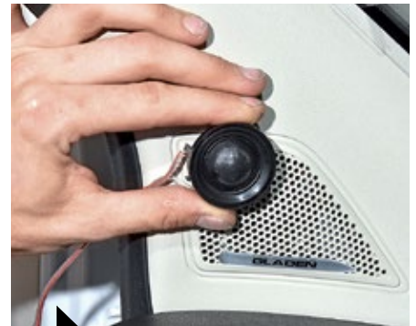
3 Im Bild: Hier die Fiat-Originalverkleidung. Auch hier lässt sich der Hochtöner un- sichtbar verstecken – aber nicht perfekt ausrichten. Fehlt dem Basisfahrzeug ein Hochtöner, muss der Monteur Boxenkabel zum Radio ziehen.
