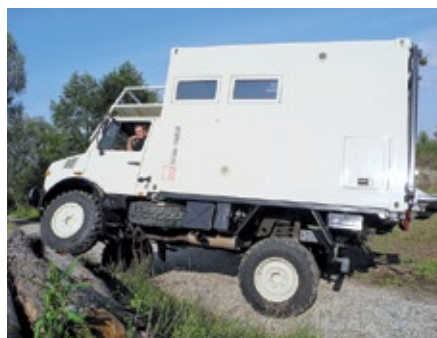
Der Hilfsrahmen nimmt die Torsionskräfte bei Verwindungen auf.
