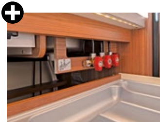
+ In Hüfthöhe montierte Gasabsperrhähne erleichtern den Alltag.
