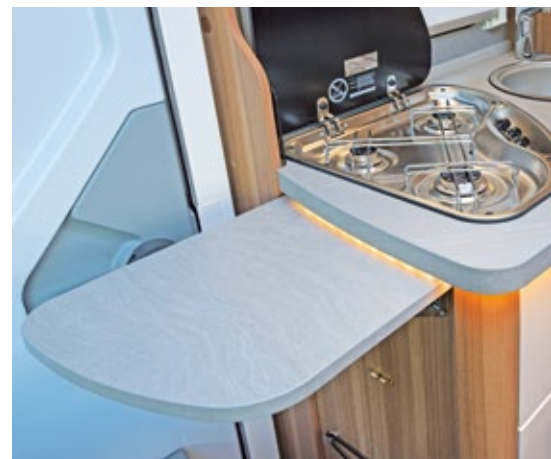
Clever gemacht: Eine abklappbare Arbeitsplatte vergrößert die Küchenablagefläche.
