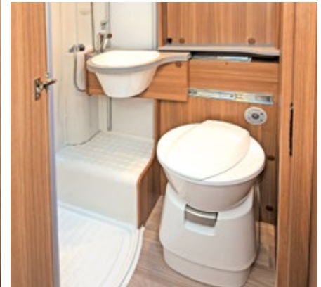
Platzsparende Lösung: Das Kunststoffwaschbecken über der Toilette lässt sich zur Seite in die Duschkabine schieben.
