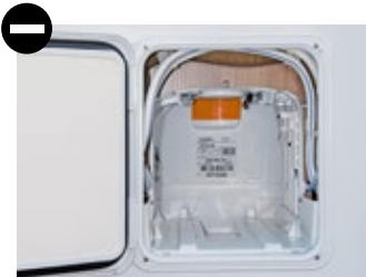
- Der Kassettenschacht der Toilette ist nicht vollständig gekapselt.
