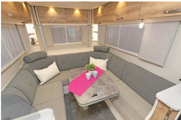
Einfallsreich: Aus der U-Sitzgruppe lassen sich Sitze in Fahrtrichtung mit Dreipunkt-Sicherheitsgurt machen.
