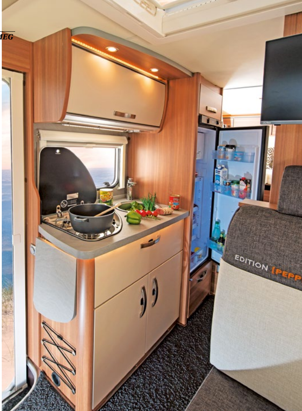
Küchencenter: Die Bordküche ist mit einem Dreiflammkocher inklusive elektrischer Zündung, großer Spüle sowie reichlich Stauraum und einem Fenster für den Dunstabzug gut ausgerüstet.
