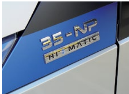
Präzise Verschlüsselung für Eingeweihte: 3,5 Tonnen zulässiges Gesamtgewicht, Gasantrieb, Achtgang-Automatik.
