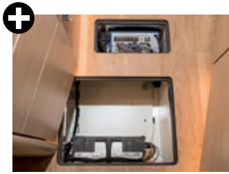
Gut zugängliche Elektrik mit Platz und Haltern für zwei weitere Bordakkus.
