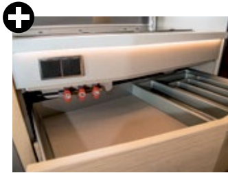
Gut erreichbare Gasabsperrröhre. Die Steckdosen sollte Hymer versetzen.
