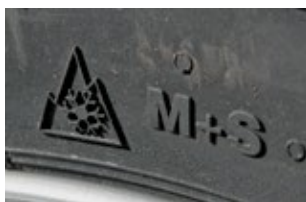
Erst das Schneeflocken-Symbol kennzeichnet einen vollwertigen Winterreifen, die MS-Kennzeichnung alleine reicht nicht.
