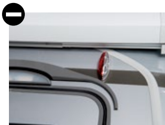
Ungünstig, wenn auch vorschrittenkonform platzierte Umrissleuchten.
