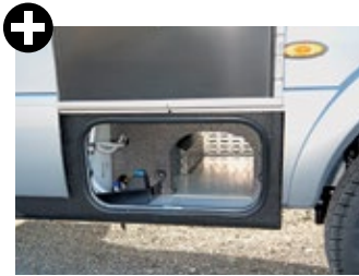
Durchladbarer, hoher Doppelboden. Frost Control gut erreichbar.
