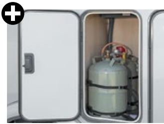
Gasflaschenkasten in rückenfreundlicher Höhe und mit Lüftungsgittern.
