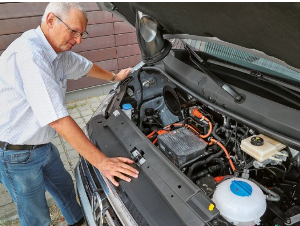
Orangefarbige Kabel warnen vor Hochvolttechnik. Der Motor arbeitet kraftvoll, sehr leise und vor allem vor Ort emissionsfrei.
