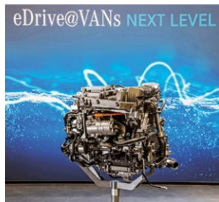
Hat das Format eines Dieselmotors, verwandelt Wasserstoff in Strom: Brennstoffzelle für den Sprinter F-Cell.
