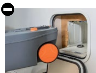
Gegen auslaufende Flüssigkeit ungeschützter Toilettenschacht.
