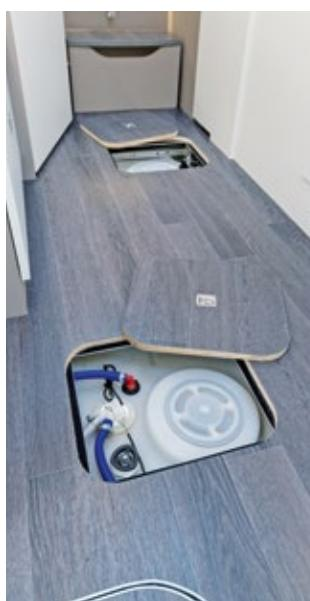
Auch hier entfleucht der Badedunst über eine Dachluke. Der Toilettenschacht des Hymer-Teilintegrierten ist im Gegensatz zu dem des Frankia Neo nicht gegen austretende Flüssigkeit gekapselt.
