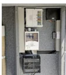
Der Toilettenschacht ist gegen Nässe gekapselt, ein Auszug erleichtert den Tausch der Gasflaschen. Die Elektrozentrale befindet sich leicht zugänglich in der Garage des Teilintegrierten. Die Versorgungskästen baut Frankia im beheizten Doppelboden des Neo ein.
