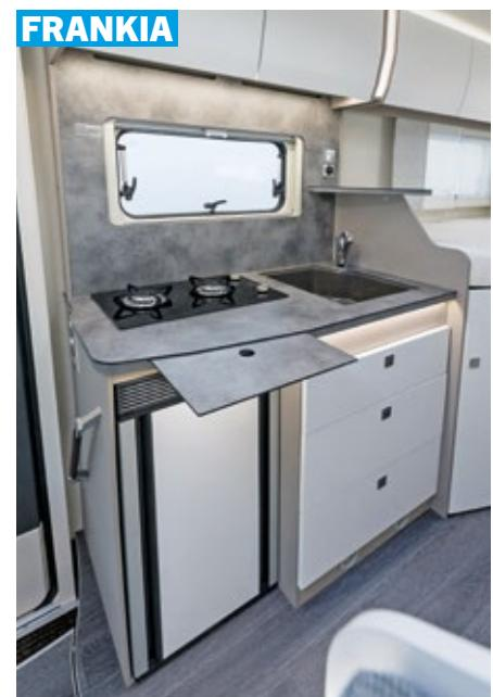
**Kleiner Kühlschrank, größere Arbeitsfläche:** die Frankia zusätzlich mit einer Arbeitsplatte zum Eihängen vergrößert. Der Zweiflammkocher sieht schick aus.
