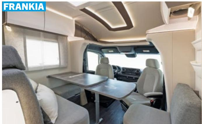
In die fünf Zentimeter breitere Kabine des Neo baut Frankia eine zusätzliche Längsbank für einen fünften Reisemobilisten ein. Der Tisch ist ausziehbar.
