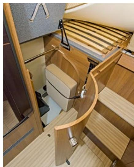
darunter mit einem entsprechend angelehnten Sitztruhendeckel aus. So gelangt der Camper mühelos an den Stauraum, ohne Lehnen- und Sitzpolster entfernen zu müssen. Weiterhin ist die Bank mit zwei Dreipunkt-Sicherheitsgurten und einer durchgehenden höhenverstellbaren Kopfstütze ausgestattet. Die bequemen drehbaren Fahrerhaussitze von Aguti sind in Höhe und Neigung verstellbar.
