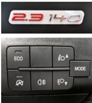
Noch ungewohnt sind die Motorenbezeichnungen. Neu ist der Schalter für die Start-Stopp-Automatik.
