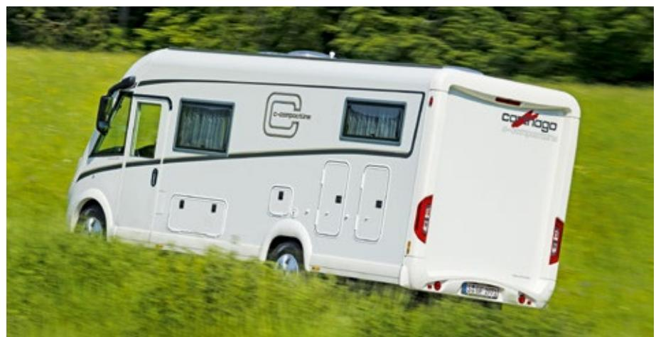
Dank Modifikationen am Mobiliar, etwa am Hubbett, wiegt der neue Carthago C-Compactline I 143 LE rund 20 Kilogramm weniger als der bisherige. Typisch: die oben gerundeten, bis ins Dach reichenden Seitenwände. ▶
