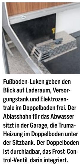
Fußboden-Luken geben den Blick auf Laderaum, Versorgungskasten und Elektrozentrale im Doppelboden frei. Der Ablachshahn für das Abwasser sitzt in der Garage, die Truma-Heizung im Doppelboden unter der Sitzbank. Der Doppelboden ist durchladbar, das Frost-Control-Ventil darin integriert.
