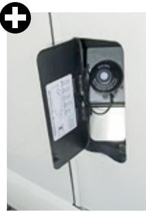
Perfekt in Karosserie eingefügter Diesel-Tankstutzen; bereits vorbereitet für einen Adblue-Stutzen.
