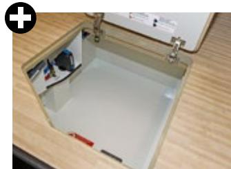
Frost Control und Hebel für Abwasserhahn prima in Doppelboden platziert.
