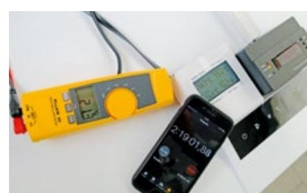
Optimales Temperaturmanagement: Die MT 110 von Büttner steht seit über drei Stunden bei minus 11 Grad in der Kühltruhe – der interne Sensor erkennt warme Zellen, die Ladung läuft.
