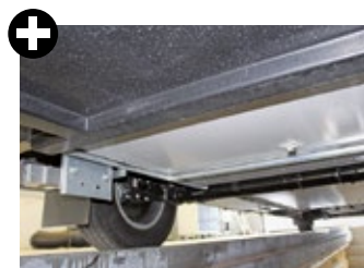
GfK-Unterboden des SLC-Chassis (weiß); selbsttragender Garagenboden.
