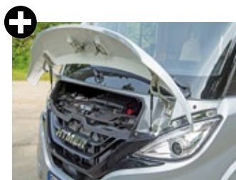
Die gut eingepasste Motorhaube öffnet von Dämpfern unterstützt.
