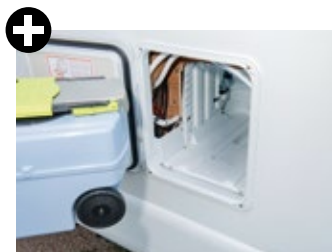
Weitgehend abgedichteter Toiletenschacht der Dometic-Toilette.
