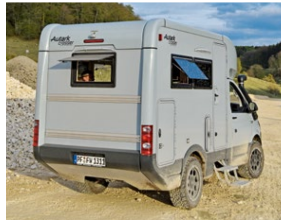
Die Schienen am Heck können ein Motorrad tragen, die Tür ist dreifach verriegelt wie eine Haustür. Mit Snorkel können auch staubige Pisten gefahrlos befahren werden.
