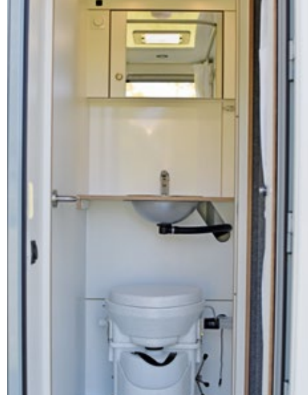
Mit Klappwaschbecken, Trocken-Trenn-Toilette und Dusche ist der Crosser-compact perfekt ausgestattet.
