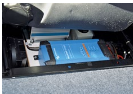
Der Sinus-Wechselrichter sorgt für stabile 230 Volt. Das Vitron-Ladegerät lädt und überwacht die Batterie.
