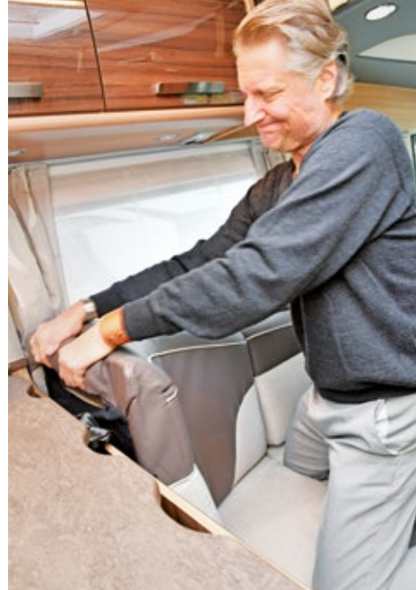
Ganz schön anstrengend geht's bei der Demontage des Rückenpolster in der Dinette zu. Die Polster sind passgenau gefertigt, verkeilen sich untereinander, verrutschen daher nicht.
