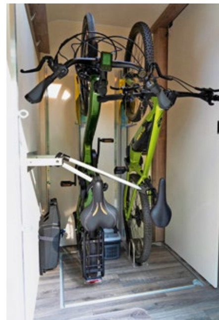
Platzsparend: Hochkant passen ins deckenhohe Heck zwei Fahrräder. Die umlaufende Rille darunter schluckt Wasser und Dreck. Vor der Schiebetür ist das Raumbad.
