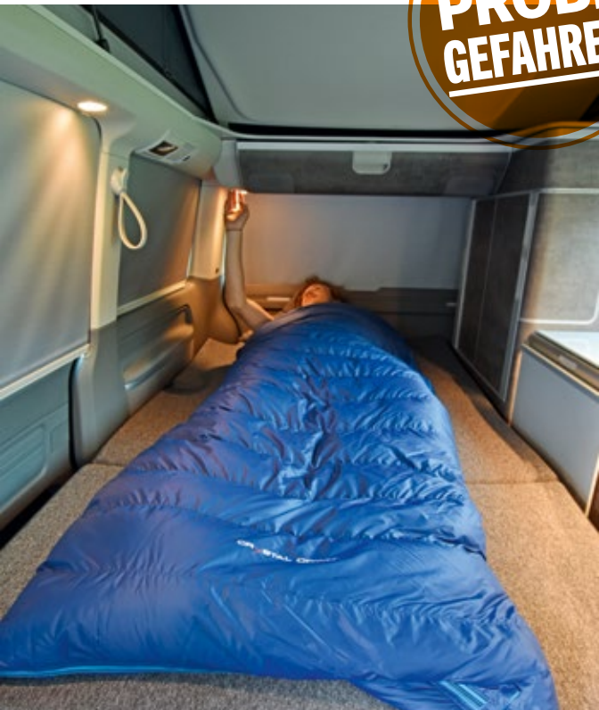
Die Beleuchtung lässt sich einzeln ansteuern und dimmen, entweder direkt an der LED oder touch-gesteuert vom Kontrollpanel aus.
