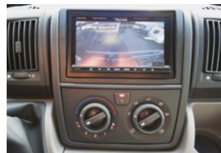
Blick nach hinten: Der Naviceiver ist mit einer Rückfahrkamera ausgestattet.
