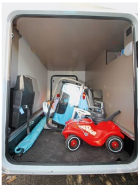
150 Kilogramm Zuladung erlaubt die große Garage. Sicherungsösen und Antirutschmatten sorgen dafür, dass während der Fahrt alles an seinem Platz bleibt. Praktisch: Steckdose für E-Bike-Akku (Basic-Paket).
