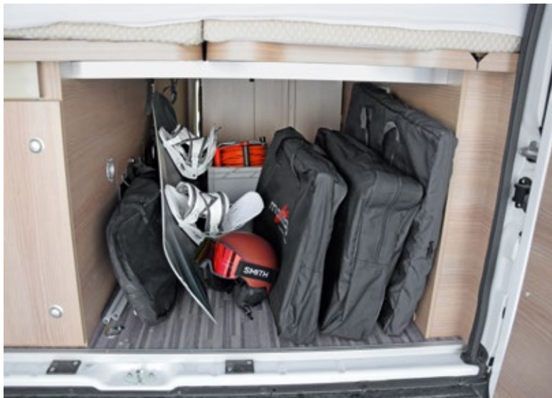
Im Stauschrank unter dem Kühlschrank und im Heckbereich kommt viel Ausrüstung unter. Die Zurrösen gehören zum Paket „Aufbau“ und kosten extra. Die verschiebbare Schottwand ist gleichzeitig Trittstufe zum Bett, weil sie klappbar ist, können längere Gegenstände durchgeladen werden.
