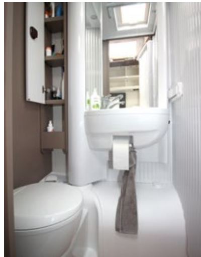
Das kompakte Variobad arbeitet mit einer Schwenkwand. Mit einem Handgriff lässt sich das Waschbecken samt großer Spiegelwand über die Toilette schwenken und schafft eine Dusche mit ausreichend Platz.
