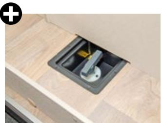
Auch der Hebel für den Hahn des Abwassertanks ist gut erreichbar.
