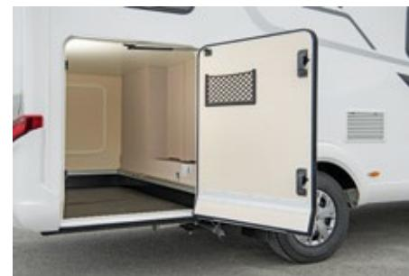
Typisch Hymer: der selbsttragende, isolierte GfK-Boden der geräumigen Heckgarage. Die rechte Tür ist Serie, die kleinere linke aber Option. Unpraktisch: Der Öffnungswinkel der rechten beträgt nur rund 100 Grad. So steht die offene Tür weit ab. Verschiebbare Zurrösen in drei Schienen sichern das Ladegut.
