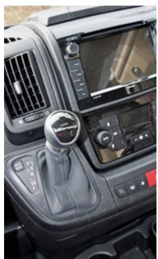
Ducato-Fahren auf neuem Niveau: Die Wandlerautomatik mit neun Gängen schaltet ruckfrei und erhöht den Fahrkomfort des Teilintegrierten erheblich. Aufpreis: 3.390 Euro.
