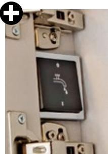
Der Schalter für die Frischwassererpumpe ist im Badschrank sehr gut zu erreichen.
