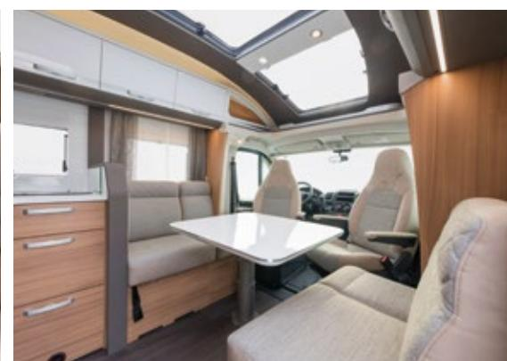
Einfallsreich: Aus den bequemen Längsbänken werden mit wenigen Handgriffen zwei vollwertige und begurtete Einzelsitze für die Fahrt. Die Tischplatte (84 mal 75 Zentimeter) lässt sich in der Mitte umklappen, um den Durchgang ins Cockpit zu erleichtern.
