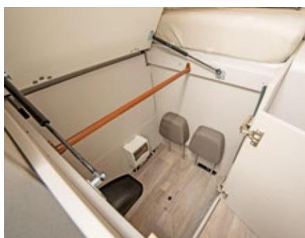
Das Doppelbett bereitet der Urlauber, indem er ein von Hymer Tablett genanntes Brett zwischen beiden Fußenden einhängt und mit einem Polster belegt. Das Tablett ist allerdings ziemlich sperrig. In beiden Fußenden bringt Hymer je einen Kleiderschrank unter. Im größeren mit aufstellbarem Deckel befinden sich Halterungen für die Kopfstützen der Sitzbank.
