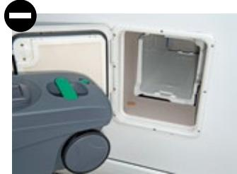
Der Toilettenschacht ist weitgehend ausgekleidet, aber nicht abgedichtet.
