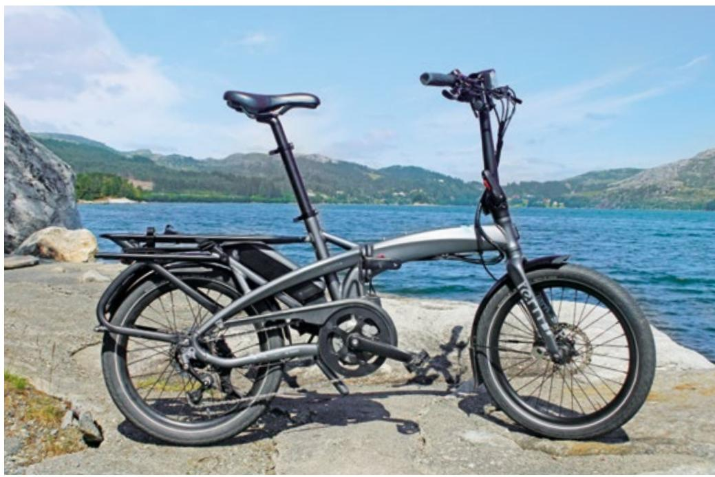
Kandidat Nummer eins: das Vektron P7i des taiwanischen Herstellers Tern. Das mit Bosch Active-Line-Mittelmotor (250 Watt), PowerPack-Akku mit 400 Wattstunden (bei 36 Volt, entspricht 11 Amperestunden) und 7-Gang-Shimano-Nexus-Nabenschaltung ausgestattete Rad ist seit rund einem Jahr für 3.199 Euro inklusive Licht und Gepäckträger erhältlich. Der Motor bietet mit Eco, Tour, Sport und Turbo vier Unterstützungsmodi und beschleunigt Fahrer und Rad auf
