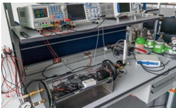
In der Prüfröhre: Alle Gaswarner unter identischen Bedingungen im Test.
