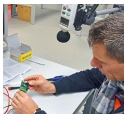
Wie laut schlägt der Gaswarner Alarm? Einzig der CNA liegt mit 70 dB weit unter dem Klassendurchschnitt – gerade noch akzeptabel. Ein Blick auf die Platine und den Sensor (und dessen Datenblatt) klärt auch, ob dieser die vom Hersteller versprochenen Gase überhaupt erkennen kann.
