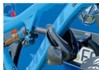
Am VeloSpace lässt sich der Abklappwinkel vergrößern – beim VW Bus öffnet die Heckklappe dann problemlos.
