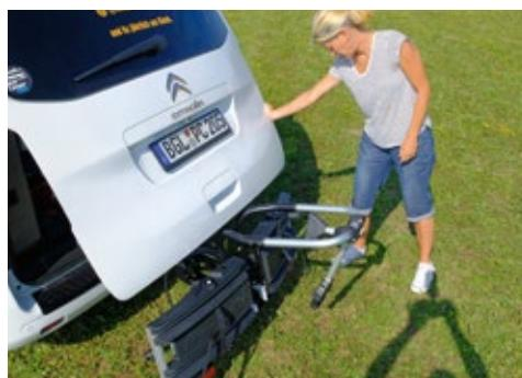
Ist der Genio Pro minimal nach hinten abgesenkt montiert, öffnet auch am Campster die Heckklappe. Klasse Rahmenhalter mit ringförmiger Schlaufe.
