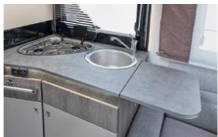
Einfallsreich: die gut zugänglichen Schalter für die elektrisch absenkbaren Betten und den Tisch an der Küchenfront, die abklappbare Küchenarbeitszusatzplatte und die Technibox mit Elektrozentrale und Frischwassertank.
