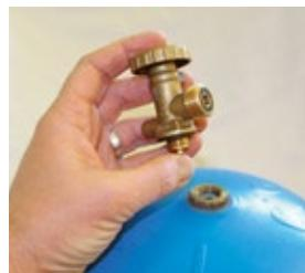
Die blauen Butangasflaschen von Campinggaz lassen sich mit einem Einschraubventil an den Gasregler des Reisemobils anschließen.
