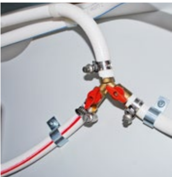
Umschaltung: Warmwasser zieht die Waschmaschine aus dem Warmwasserkreislauf der Alde-Heizung – bei laufendem Motor sogar ganz komfortabel, aufgewärmt aus dem Motorkreislauf.
