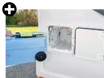
Der Schacht der Kassettentoilette von Dometic ist sehr gut abgedichtet.
