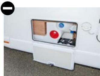
Trotz Einfüllstutzen fürs Wasser ist das Servicefach nicht abgedichtet.
