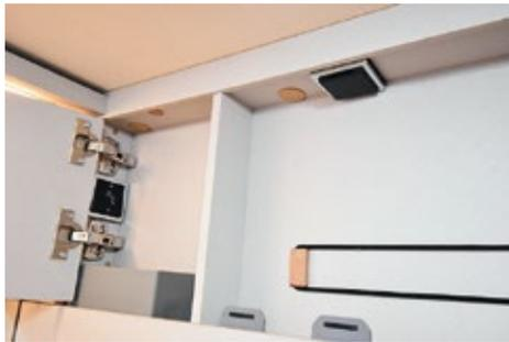
Im Kosmetikschrank im Bad finden sich der Schalter für die Frischwasserpumpe sowie eine 230-Volt-Steckdose. Der Ablasshahn für den Abwassertank ist im vorderen Sims der Heckgarage eingelassen und gut erreichbar. Frisch- und Abwassertank sind frostgeschützt hinter der Hinterachse eingebaut.
