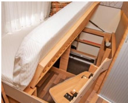
Der Bettstaukasten geht in den Heckstauraum über. Unser Foto zeigt außerdem die eingeklappte Bett-erweiterung, die das zulaufende Fußende teilweise kompensiert.
