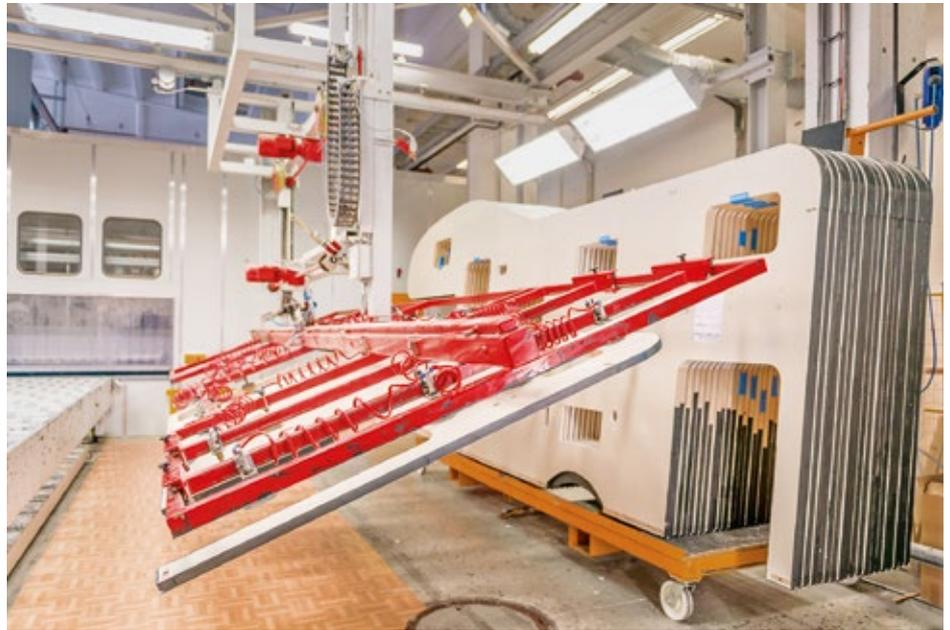
Ein Dach wird montiert: Trotz Maschinenunterstützung bleibt für die Mitarbeiter im Carthago-Werk viel Handarbeit (links).
