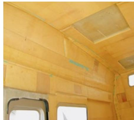
Vorteil Monocoque: Es entsteht ein steifer, leichter und absolut wasserdichter Aufbau. Doch der Bau ist aufwendig und teuer. Mobile mit Monocoque-Kabine sind entsprechend hochpreisig und selten im Angebot. Neben dem La Strada Nova entstehen zum Beispiel auch die Silverdream-Modelle von Wanner in dieser Bauweise.
