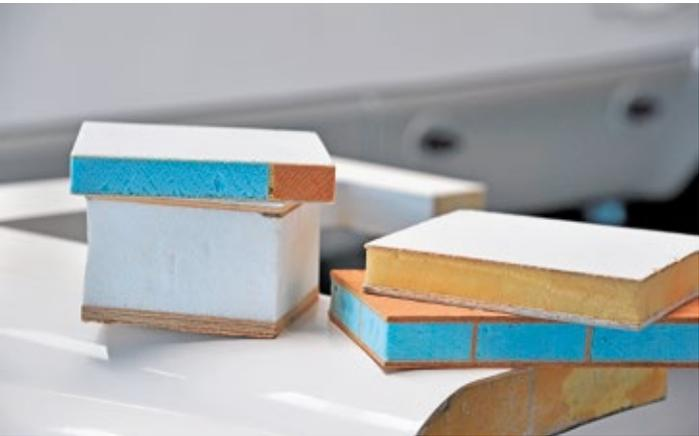
**Innenleben:** Aufgeschnittene Wandelemente zeigen den Sandwichtaufbau. Die Isoliermaterialien sind unterschiedlich eingefärbt: EPS (weiß), XPS (blau) und PU-Schaum (gelb). Die Beplankung außen und innen bilden Aluminium, GfK oder Sperrholz.
