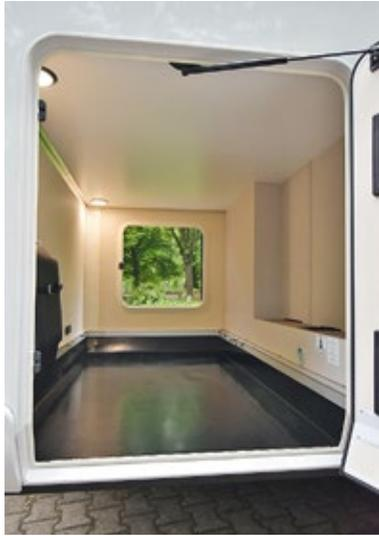
Die zweitürige Heckgarage hat einen selbsttragenden, isolierten Boden. Verschiebbare Ösen in Schienen sichern das Gepäck.
