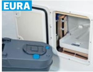
So und so: Der Schacht der Kassettoilette ist nicht vollständig gekapselt. Die Gasabsperrhähne sind dafür aber in bequemer Hüfthöhe eingebaut.
