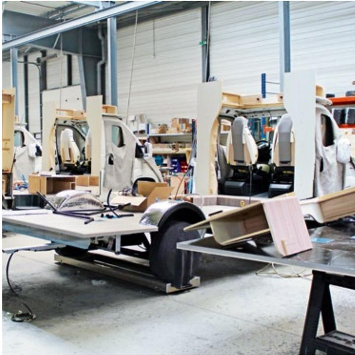
Los geht's: Die Bodenplatte ist auf dem Chassis montiert, erste Möbelteile liegen bereit. Schritt für Schritt entsteht hier ein teilintegriertes Wohnmobil.
