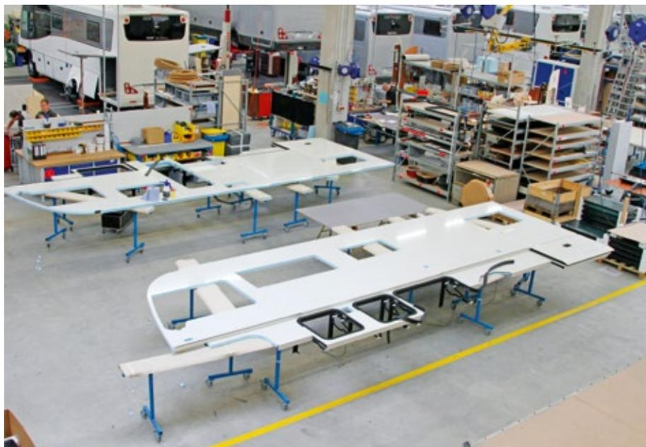
**Flachgelegt:** Die Seitenwände dieses Integrierten werden in liegender Position auf ihren Einbau vorbereitet. Carthago verwendet für die Außen- und Innenseite der Sandwich-Wände Aluminium. Das Material kommt auch auf der Innenseite des Daches zum Einsatz, so entsteht ein faradayscher Käfig, der Blitzschläge ableitet.
