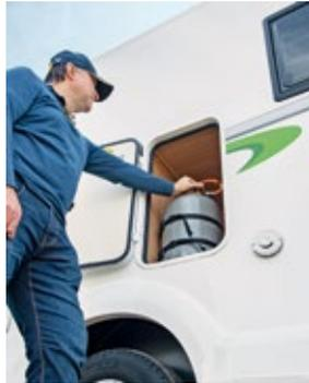
Angenehm: Der Gasflaschenkasten ist in Hüfthöhe montiert, was den Flaschentausch erleichtert.
