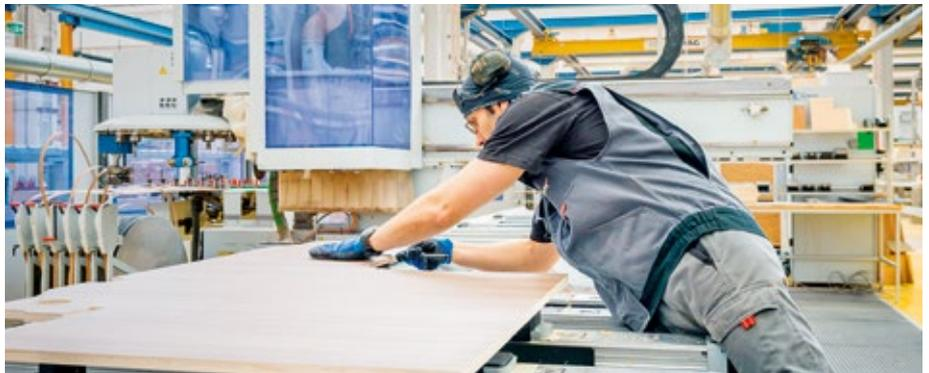
**Holzarbeit:** Sperrholz kommt bei Carado nicht nur für die Möbel zum Einsatz, sondern auch zur Verstärkung der Wandkonstruktion und als Bodenplatte. Dort wird ein Sandwich mit EPS (Styropor) als Isolierung verwendet. Damit am Unterboden keine Feuchtigkeit eindringt, ist die Sperrholzplatte mit einem Schutzanstrich versehen.
