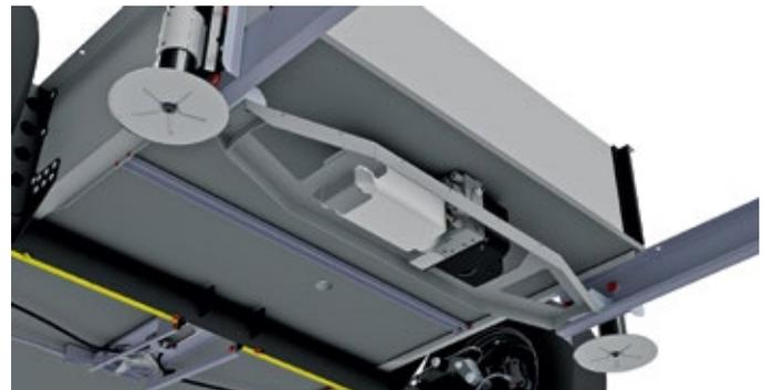
Stabilen Halt und waagrechten Stand verspricht das HLC Smart-Hubsstützensystem von Goldschmitt. Praktisch ist die integrierte Wiegefunktion.
