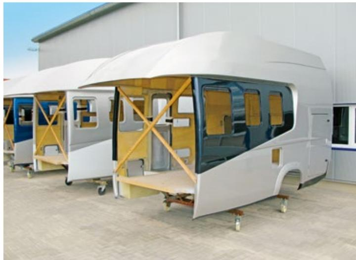
Besondere Konstruktion: Ein Monocoque, wie hier für den La Strada Nova, entsteht als ein Teil in einer Form. Seitenwände, Heckwand und Dach werden also nicht einzeln gefertigt und dann verklebt und verschraubt wie sonst üblich.
