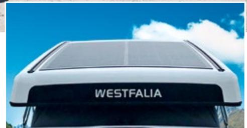
Mehr Autarkie: Westfalia bietet für die Aufstelldächer der Columbus-Modelle ein flach integriertes Solarmodul.
