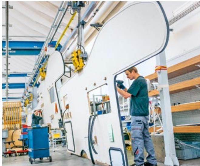
**Plattenlager:** Carado verwendet für die Seitenwände Alu-Sandwich mit einer einfachen EPS-Isolierung (Styropor).
