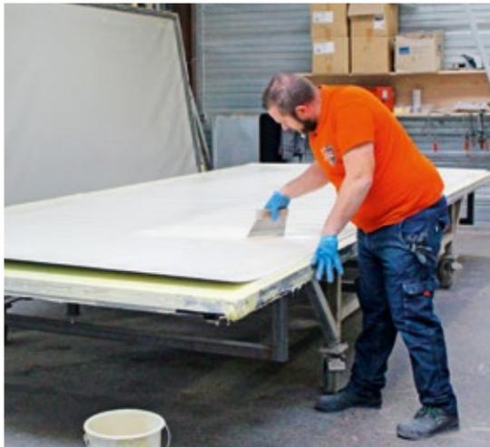
Handarbeit: Dach, Boden, Seitenwände und Heckwand entstehen bei Fleurette als GfK-Sandwich mit XPS-Isolierung.
