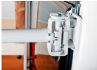
Der Van Bike 2 wird an den Scharnieren der Hecktüre arretiert.
