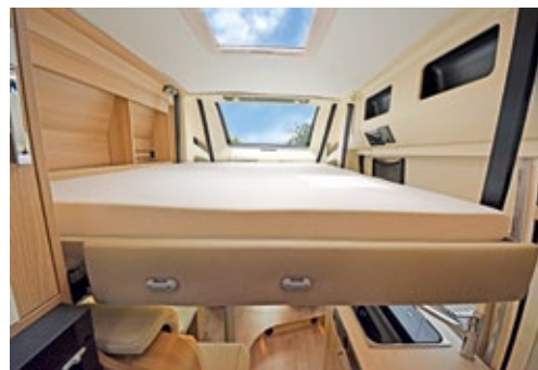
Das elektrische Hubbett mit Holzlattenrost hängt wackelfrei an vier Gurten. Großes Plus: der Blick durchs Dachfenster.
