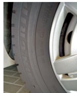
Ziemlich alt: Laut DOT-Nummer sind die Reifen in der 44. Kalenderwoche im Jahr 2007 gefertigt worden und sollten dringend getauscht werden.
