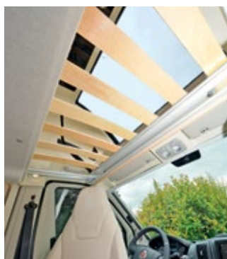
Das Hubbett mit aufwendiger Mechanik nutzt jeden Zentimeter im Dach.
