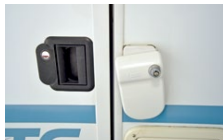
Beruhigend: Die Türen des Pilote verfügen über einen zusätzlichen Einbruchschutz von Fiamma.
