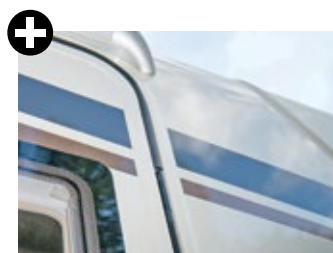
Trockener Einstieg: Die Regenrinne über der Tür funktioniert effektiv.
