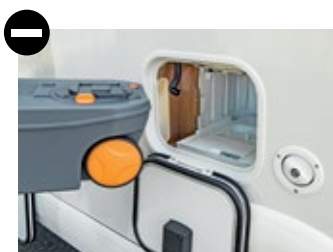
Geht besser: Der Schacht der Kassettoilette ist nicht gut abgedichtet.
