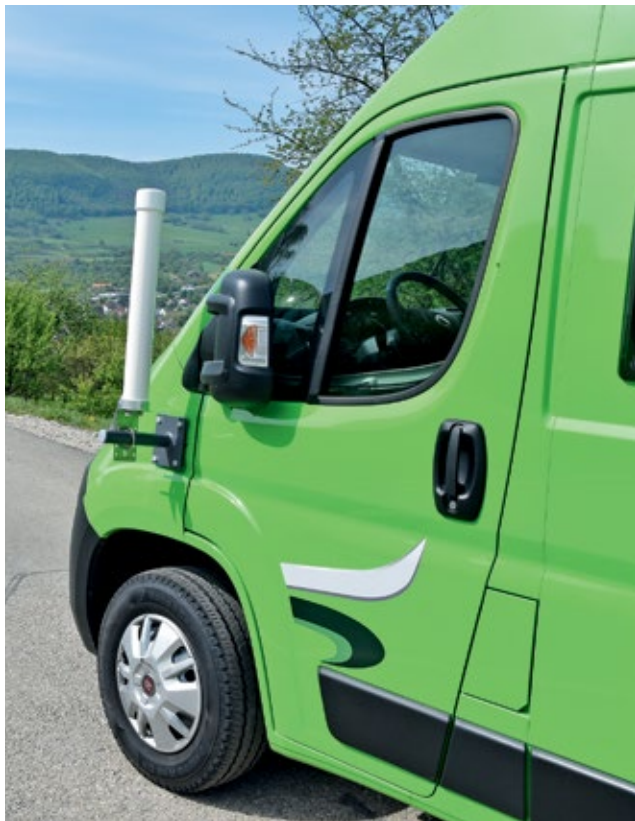
Auffällig: Die LTE MIMO Omnistrahler Antenne von FTS Hennig lässt sich an einem Saugnapfhalter und damit wiederum am Fahrzeug befestigen. Sie sollte nur bei stehendem Fahrzeug verwendet werden und kostet ca. 175 Euro.
