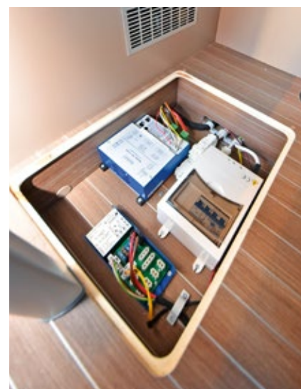
Gut gemacht: Kleider- und Wäscheschrank zwischen Sitzbank und Bad lassen sich prima nutzen. Die Elektrik verbaut Etrusco gut zugänglich im Podest der Sitzgruppe, Deckel anheben genügt.
