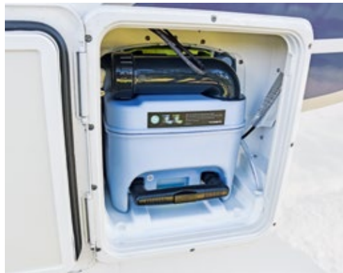
Licht und Schatten: Der WC-Schacht ist sehr gut abgedichtet. Die Kabel im Service-Fach sollte Ahorn sorgfältiger verlegen.
