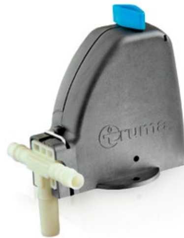
Truma Combi Heizungen haben zum Schutz vor Frostschäden ein integriertes FrostControl. Das Ablassventil öffnet automatisch bei drei Grad Celsius.
