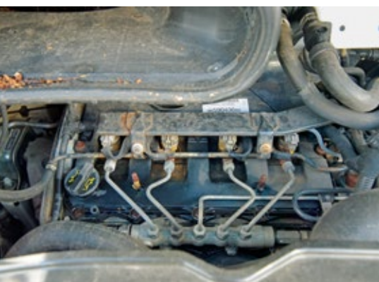
Guter Zustand: Der Motorraum ist trocken.
