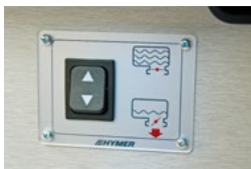
Komfortabel: Der Abwassertank öffnet serienmäßig elektrisch per Schalter an der Sitzbank. Campingstühle und -tisch finden ihr Plätzchen im Heckstauraum unter dem Querbett.
