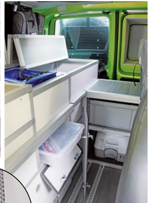
Links: Für den Selbstausbau eines Transporters sind Sperrholzplatten bestens geeignet. Sie lassen sich leicht verarbeiten. Unten: auf die Funktion reduziert, dafür besonders robuster Möbelbau aus Aluprofilen und Verbundplatten.
