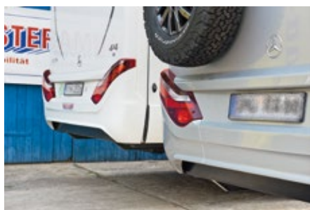
Hinten der MLT mit Roadmaster-Optimierung. Deutlich zu sehen – das angehobene Heck.
