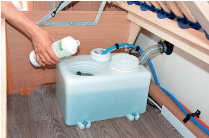
Der Frischwassertank – hier ein Überflurtank in einem Caravan – sollte regelmäßig gereinigt und desinfiziert werden.
