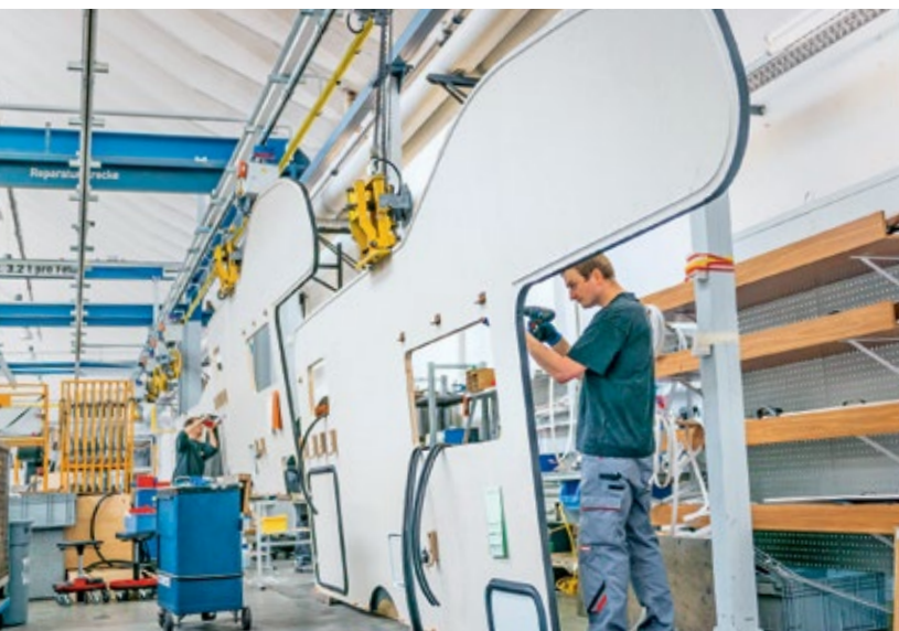
Blick in die Produktionshalle bei Hymer in Bad Waldsee: Die Fertigung von Wohnmobilen ist zu einem großen Teil Handarbeit. Oben rechts: Blau, weiß oder gelb ist der Isolierschaum in den Sandwich-Wänden.
