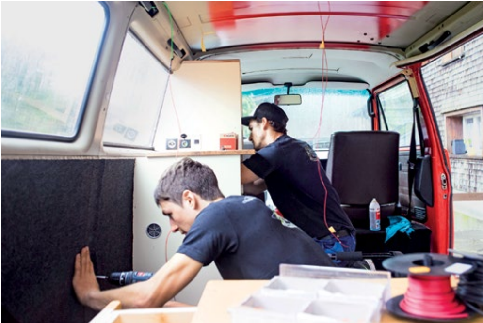
Links: Für den Selbstausbau eines Transporters sind Sperrholzplatten bestens geeignet. Sie lassen sich leicht verarbeiten. Unten: auf die Funktion reduziert, dafür besonders robuster Möbelbau aus Aluprofilen und Verbundplatten.
