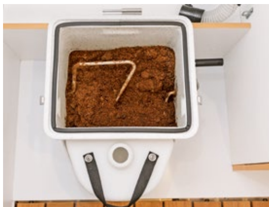
Ein TTT-Klassiker: Die Trockentrenntoilette von Nature's Head. Das integrierte Rührwerk unterstützt die geruchsfreie Kompostierung im Feststofftank.
