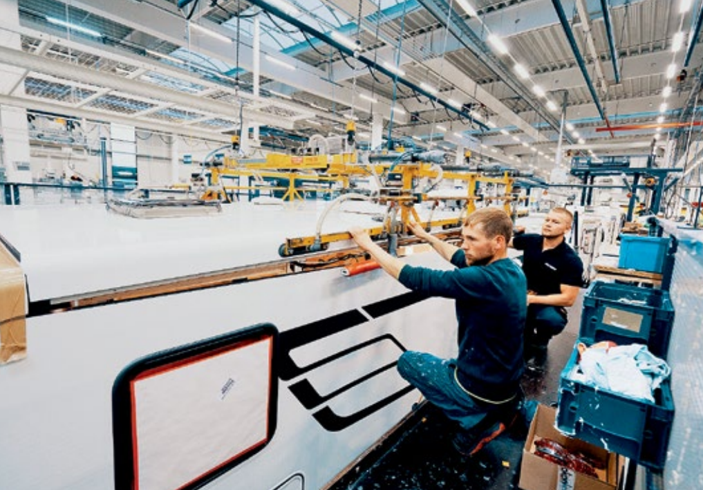
Blick in die Produktionshalle bei Hymer in Bad Waldsee: Die Fertigung von Wohnmobilen ist zu einem großen Teil Handarbeit. Oben rechts: Blau, weiß oder gelb ist der Isolierschaum in den Sandwich-Wänden.
