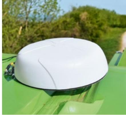
**Gute Lösung:** Eine LTE MIMO Magnethaftantenne lässt sich unkompliziert auf dem Fahrzeugdach platzieren, da keine Festmontage nötig ist. Die Antenne von Panorama Antennas gibt es bei FTS Hennig für ca. 80 Euro (oben links). Die leistungsfähige 4x4 MIMO Fahrzeugantenne (4G/5G) von Panorama Antennas – hier zu Demonstrationszwecken aufs Fahrzeugdach gelegt – wird fest montiert und soll besten Empfang gewährleisten. Sie rangiert mit rund 270 Euro am oberen Ende der Preisskala (oben rechts).
