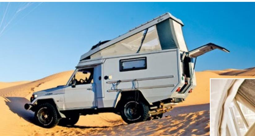
Tom's Fahrzeugtechnik veredelt den Land Cruiser mit Aufstell- oder Hochdach und auf Wunsch mit spezieller Rahmenverlängerung zum komfortablen Fernreisefahrzeug mit leistungsfähiger Allrad-Kompetenz.
