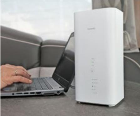
Installation am Beispiel Oyster Connect von ten Haaft: LTE- und WLAN-Antennen sitzen auf dem Dach, ein Router im Fahrzeug erzeugt ein lokales WLAN, in das sich Geräte einwählen.
