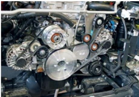
Die 230-Volt-Lichtmaschine wird vom Keilriemen angetrieben - unter Volllast verbraucht der Motor etwa einen Liter mehr.
