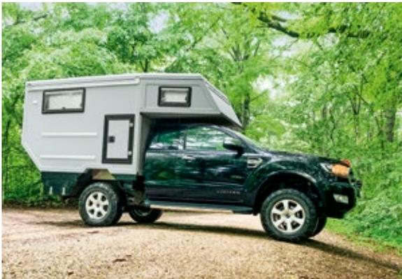
Die Exped 24HD Kabine baut Pickupback mit komplett verschweißten Rahmen aus Winkelprofilen und 40 Millimeter starken Gfk-Sandwichplatten. Im Aufstelldach: ein riesiges Bett von 2,2 mal 1,86 Metern. Pickupback verspricht gewaltige 1.875 Liter Stauraum bei einem Leergewicht ab 450 kg.
