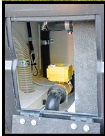
► Wasser ablassen leicht gemacht: Der elektrische Kugelhahn öffnet auf Knopfdruck.
