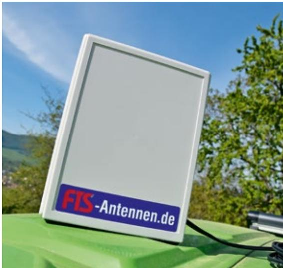
**Simpel:** Die FTS Complete MIMO LTE Allbandantenne wird aufs Fahrzeugdach gestellt oder mit einem Saugnapfhalter befestigt und kostet ca. 77 Euro. So ist die Antenne schnell einsatzbereit, erfordert aber ein stehendes Mobil.
