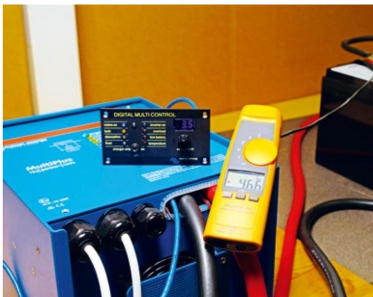
Minimal: Der Ruhestrom am ICC von Büttner Elektronik liegt bei schlanken 1,5 Ampere. Werden keine Verbraucher aktiviert, schaltet der ICC nach 10 Minuten komplett ab.
