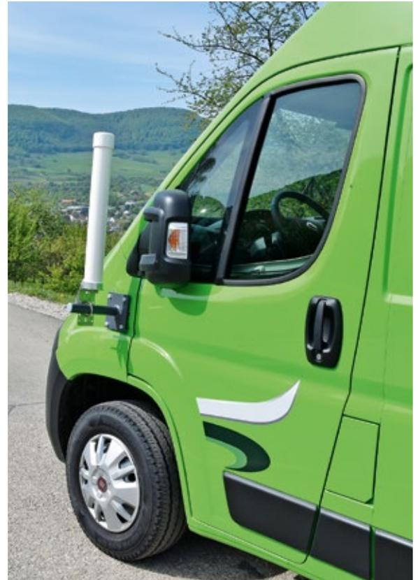
**Auffällig:** Die LTE MIMO Omnidirektionaler Antenne von FTS Hennig lässt sich an einem Saugnapfhalter und damit wiederum am Fahrzeug befestigen. Sie sollte nur bei stehendem Fahrzeug verwendet werden und kostet ca. 175 Euro. Links im Bild: eine kompakte Magnethaftantenne (2G/3G/4G) für ca. 35 Euro.
