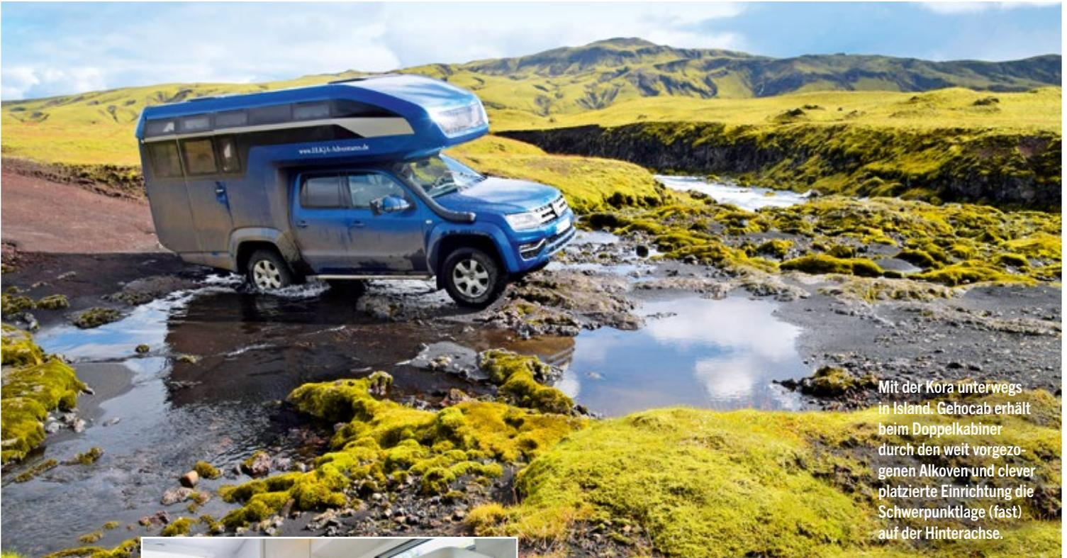
Mit der Kora unterwegs in Island. Gehocab erhält beim Doppelkabiner durch den weit vorgezogenen Alkoven und clever platzierte Einrichtung die Schwerpunktlage (fast) auf der Hinterachse.
