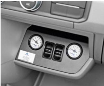
Serienmäßig verbaut Knaus beim Van Ti Plus eine Zusatz-Luftfederung an der Hinterachse. Die Offroad-Fähigkeiten des Fahrzeugs verbessert das nicht, wohl aber den Fahrkomfort auf der Straße. Empfehlenswert: Fürs Gelände nützlicher ist die optional erhältliche Differenzialsperre.
