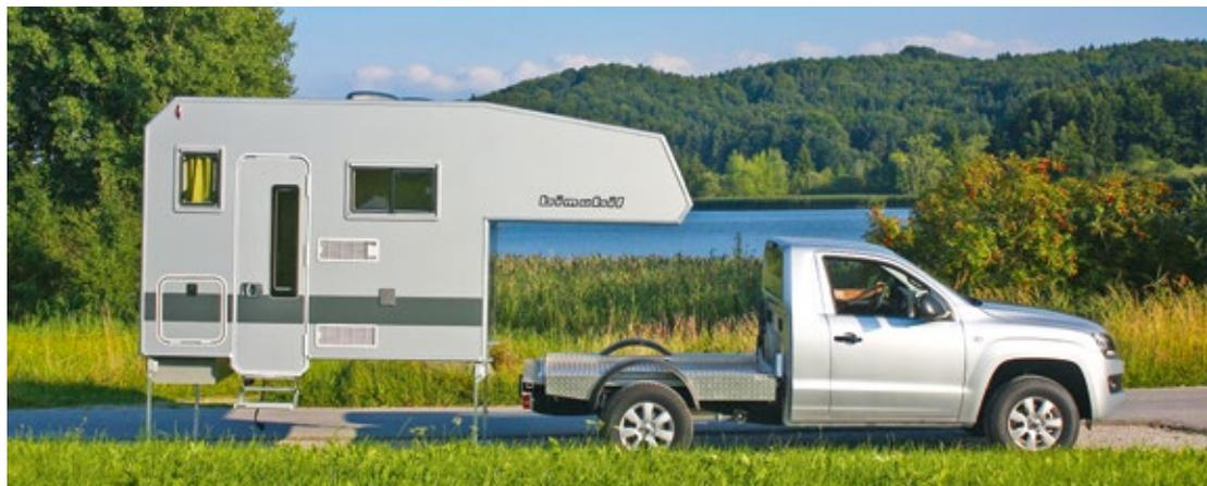
gleichem Raumangebot und besserer Schwerpunktlage möglich. Durch Zentrierhilfen gelingt das Aufsatteln viel leichter, wirklich schnell und komfortabel platzierte Verschraubungen halten die Kabine sicherer am Platz als
