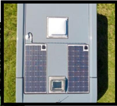
▲ 2 mal 100 Watt Solar-verklebte Panels. Kleines Manko: Die nicht unterlüfteten Panels erreichen nicht die Leistung und Lebensdauer von Glasmodulen.
