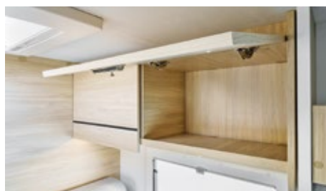
Elegant gelöst: Die Oberschränke werden mit integrierten und nicht sichtbaren Verschlüssen bestückt.
