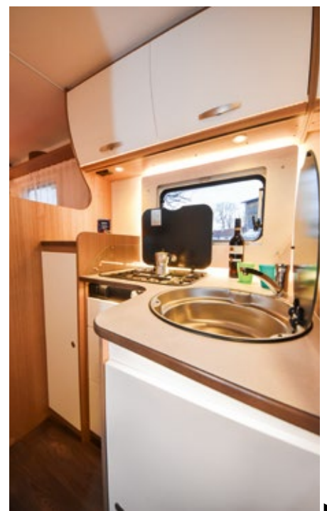
Die Küche des Integrierten bietet genug Stauraum und ist schön beleuchtet. Was fehlt, ist eine elektrische Zündung für den dreiflammigen Gasherd mit Gussrost. Nettes Zubehör: herausnehmbare Faltboxen im Unterschrank (oben).
