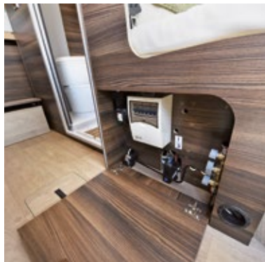
Bequemes Schlafzimmer: Umlaufende Oberschränke und guter Liegekomfort überzeugen. Weniger optimal: Die Verkleidung am Kopfende verringert die nutzbare Länge (unten). 230-Volt-Sicherung, Frostschutz-Ventil und Gashähne unter der Sitzbank (links).
