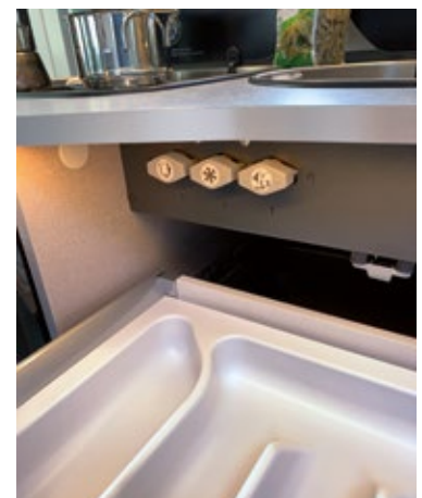
Gut gemacht: Die Gasabsperrhähne sind in Hüfthöhe montiert, die große Küchenspüle misst 40 Zentimeter im Durchmesser.
