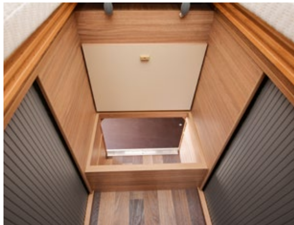
Die beiden Türen der Heckgarage haben doppelte Verriegelung und Zentral-schloss. Die untere Bettstufe birgt eine Durchreiche in den Laderaum.
