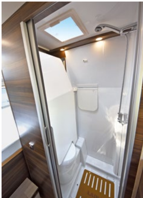
Flexibles Bad: Wer die Waschtischwand zur Seite über die Toilette schwenkt, hat viel Platz zum Duschen. Hinter der Schwenkwand verbirgt sich ein Fenster – gut zum Lüften.
