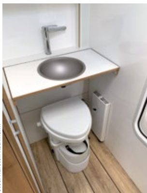
Eine Drenntoilette sichert lange Unabhängigkeit von Entsorgungsstationen.
