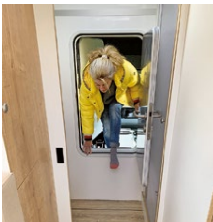
Kein Faltenbalg, aber zwei abschließbare Türen für den Durchstieg von der Fahrer- in die Wohnkabine.
