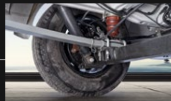
Extrem leichte Blattfedern aus Hightech-Kunststoff
