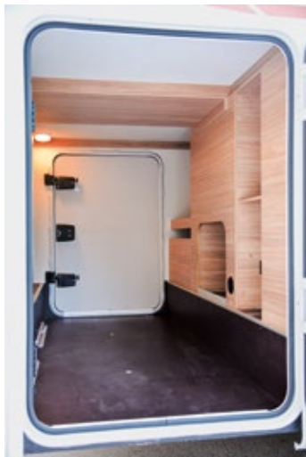
Die beiden Türen der Heckgarage haben doppelte Verriegelung und Zentral-schloss. Die untere Bettstufe birgt eine Durchreiche in den Laderaum.
