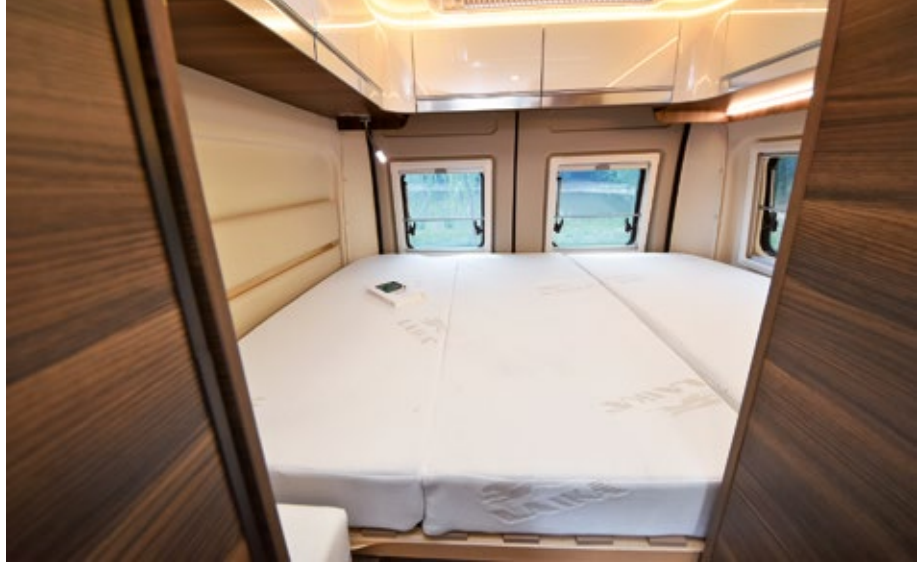
Bequemes Schlafzimmer: Umlaufende Oberschränke und guter Liegekomfort überzeugen. Weniger optimal: Die Verkleidung am Kopfende verringert die nutzbare Länge (unten). 230-Volt-Sicherung, Frostschutz-Ventil und Gashähne unter der Sitzbank (links).
