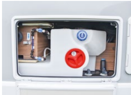
Standard bei Knaus: Frischwasser-Befüllung, Ablass­ hähne und Frost Control gut erreichbar im Servicefach, dessen Kunststoffwanne eine Abdichtung fehlt.
