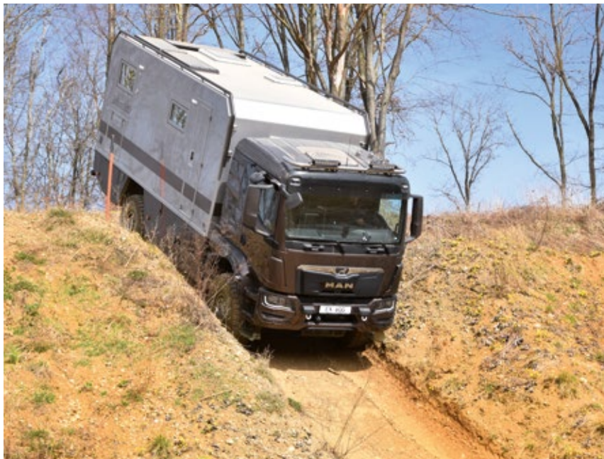
Die Kabine besteht aus holzfreien Sandwichplatten, mit Alu-Einlagen zur Möbelbefestigung. Echtglasfenster von KCT.
