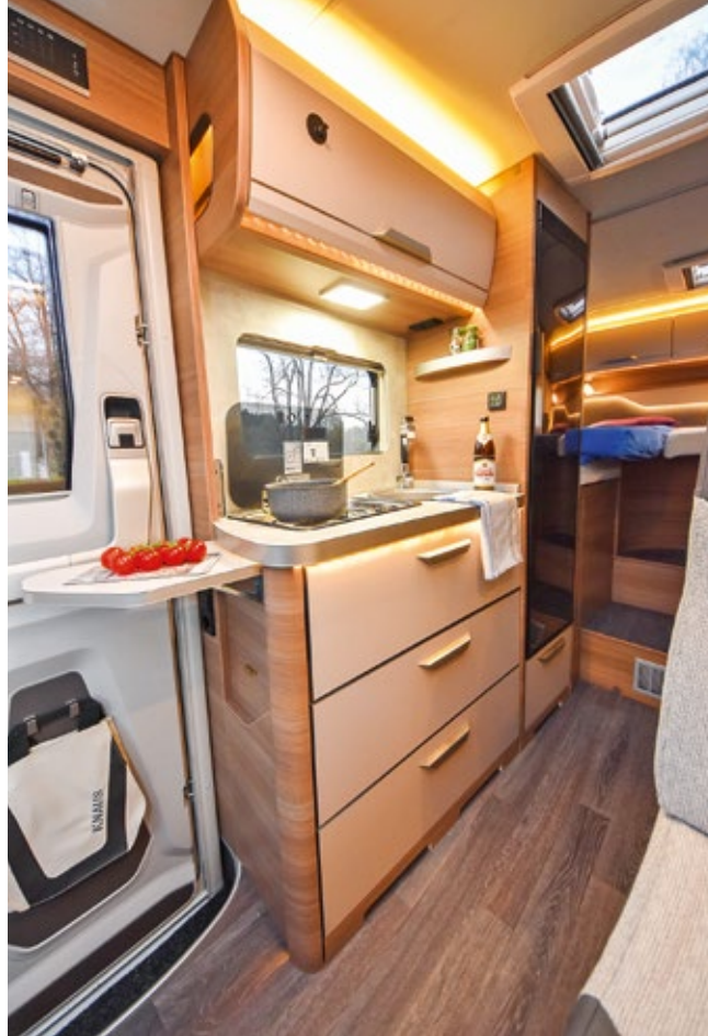
Kompakter Küchenblock mit ausreichend tiefer Rundspüle, Zweiflamm-Kocher mit elektrischer Zündung und Klappbrett. Der Absorberkühlschrank fasst üppige 142 Liter.
