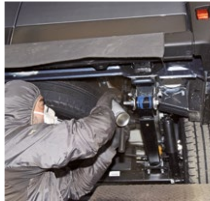
Kurz vor Schluss, wenn alles eingebaut ist, wird die Gasanlage geprüft. Einer der letzten Schritte ist der Rostschutz von unten.
