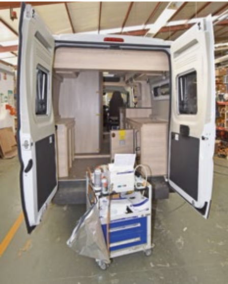
Kurz vor Schluss, wenn alles eingebaut ist, wird die Gasanlage geprüft. Einer der letzten Schritte ist der Rostschutz von unten.
