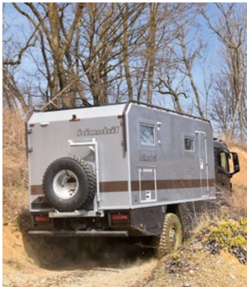
Die Kabine besteht aus holzfreien Sandwichplatten, mit Alu-Einlagen zur Möbelbefestigung. Echtglasfenster von KCT.
