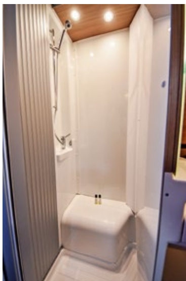
Variabel: Waschtischwand übers WC geschwenkt, schon ist die 60 mal 78 Zentimeter große Dusche bereit. Das Podest stört kaum.
