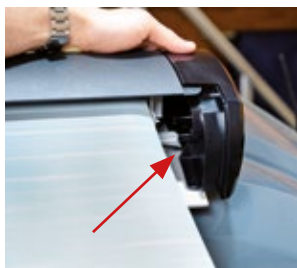
STEP 3: Rastnase innen/unten durch gleichzeitiges Anheben der Endkappe und leichtem Schub lösen.
