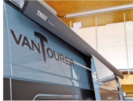
Wie deutlich zu sehen, die Markise kann bei geöffneter Schiebetüre nicht herausgekurbelt werden.
