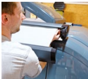
STEP 1: Schraube innen an Endkappe mit Schraubendreher herausdrehen.
