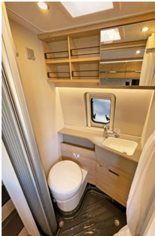
Nasszelle und Kassetten-Schacht des Testwagens entsprechen dem Vorserienstand. Bei Kundenfahrzeugen sollte der Hersteller Fugen abdichten und die offenen Schnittkanten versiegeln.
