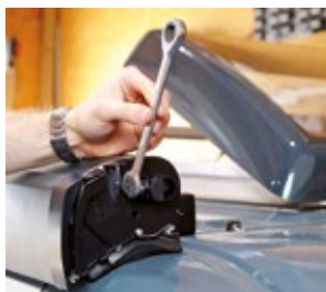
STEP 5: Die Schraube zum Einstellen des Schließmechanismus ist nun frei zugänglich. Drehen Sie sie etwas im Uhrzeigersinn, um die Markise weiter zu schließen.
