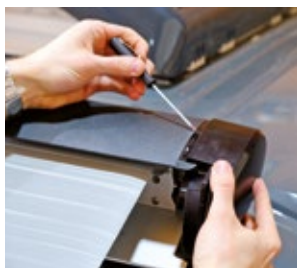
STEP 4: Hier ist die Endkappe oben schon etwas zur Seite gekippt, um zu verdeutlichen, wo das Werkzeug die Rasterung lösen muss.
