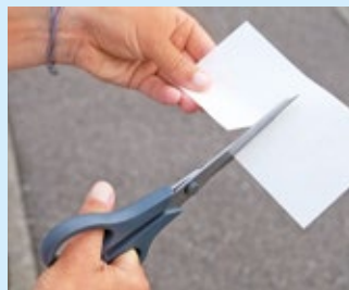
STEP 2: Klebestreifen, falls nötig, zuschneiden. Für unser kleines Loch reicht locker ein halber Streifen. Bei größeren Rissen besser großflächig ausbessern.
