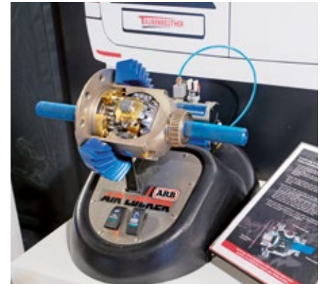
Taubenreuther war nur einer von vielen Ausstellern von Technikkomponenten. Hier eine nachrüstbare Differenzialsperre von ARB, die diversen Allradfahrzeugen auf die Sprünge hilft.
