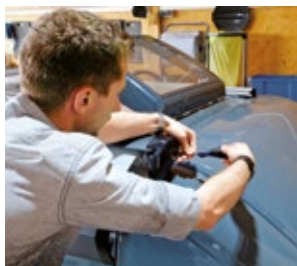
STEP 2: Schrauben hinten/unten herausdrehen.
