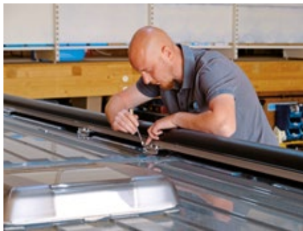
Die Dachmarkise lässt sich an den Adapterplatten verschrauben und leicht wieder demontieren.
