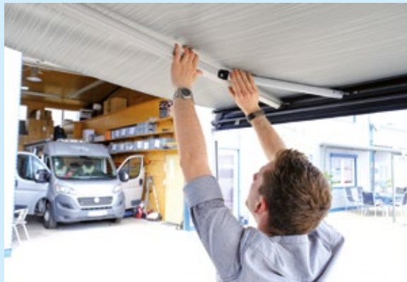
Spannarmer stabilisieren die Markise exzellent. Das Tuch wird durch sie hervorragend gespannt. Sie sind teils nachrüstbar.
