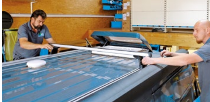
Zwei Profilschienen werden auf dem Dach verklebt und verschraubt, Querträger können bequem stufenlos verschoben und platziert werden.
