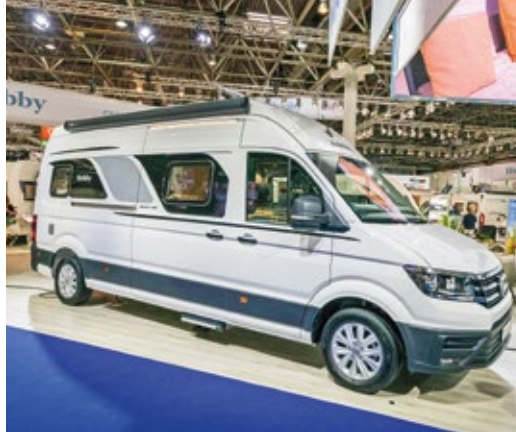
Die VW-Crafter-Basis mit Superhochdach beschert dem Maxia Van 680 ET trotz Doppelboden zwei Meter Stehhöhe.
