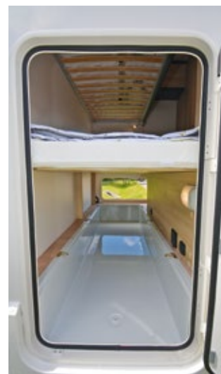
Der Heckstauraum ist von beiden Seiten aus zugänglich. Klappt man das untere Etagenbett hoch, wird er zur Heckgarage. Der Garagenboden ist isoliert. Itineo montiert Zurrösen, LED-Leuchte und 230-Volt-Steckdose.
