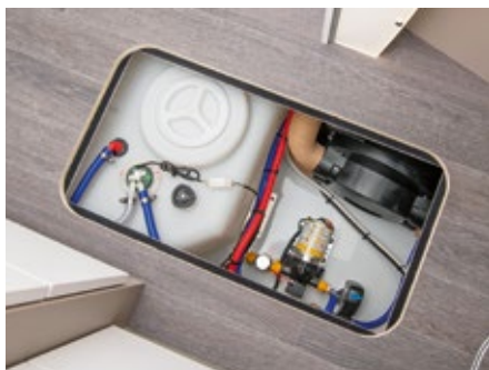
Das Bodenaufach am Einstieg ist sehr praktisch und in Alu-Leisten gefasst. Bodenausschnitt und Deckel aus Sperrholz der übrigen Bodenluken sind beim Testfahrzeug hingegen nicht versiegelt.
