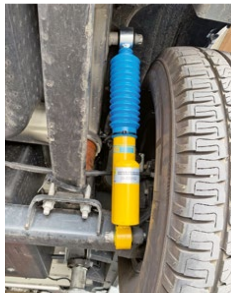
Fahrwerksoptimierung bei ORC. Die Dämpfer an der Hinterachse sind schnell gewechselt – vorn muss sich der Monteur übers Armaturenbrett Zugang zur oberen Dämpferaufnahme (Domlager) schaffen.
