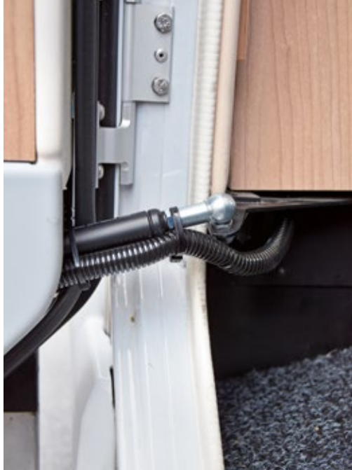
Kleiner Defekt, große Wirkung: Der gebrochene Stopper (oben) der Fahrtür zog Probleme der Elektronik nach sich. Nun sind Stopper und Kabel wieder unversehrt (oben rechts).
