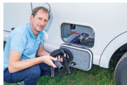
Für den Anschluss an ein Abwassersystem mag der lange Schlauch bequem sein. An der Entsorgungsstation ist er unhandlich. Er lässt sich aber kürzen.
