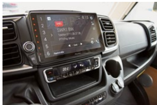
Wieder einsatzbereit: Dank repariertem Fahrtür-Stopper samt Kabelstrang zeigt die Rückfahrkamera (links) wieder ein Bild an. Das Radio macht nicht mehr bei jedem Motorstart einen Reset.
