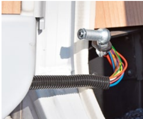
Kleiner Defekt, große Wirkung: Der gebrochene Stopper (oben) der Fahrtür zog Probleme der Elektronik nach sich. Nun sind Stopper und Kabel wieder unversehrt (oben rechts).
