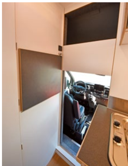
Clever: Ein Klappbrett im Durchgang zum Fahrerhaus schafft viel Arbeitsfläche in der Küche. Diese schließt die Wohnkabine nach vorn ab und bietet ausreichend Stauraum. Zum Fahrerhaus gibt es eine Schiebetür.
