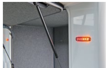
Die riesige Heckklappe zur Garage ist ein Alleinstellungsmerkmal des Frankia. Zusatzleuchten warnen andere Verkehrsteilnehmer.
