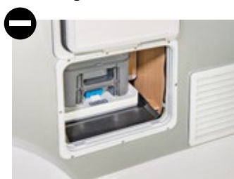
Toilettenschacht mit nahezu nutzloser Auffangwanne.
