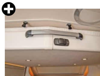
Stabiles manuelles Hubbett mit zentraler Entriegelung.
