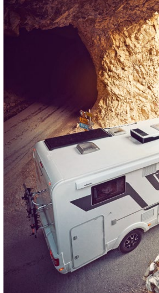
Nicht optimal: Das Dachfenster neben dem Solarpanel kann, einmal geöffnet, dieses abschatten – der Ertrag sinkt.
