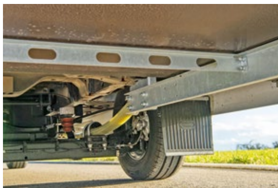
Am Unterboden gefällt die stabile Rahmenverlängerung unter der Heckgarage ebenso wie die Hinterachse mit recht feinfühlig ansprechenden Längsblatfedern aus Kunststoff. Gasflaschenkasten mit schmaler Tür.
