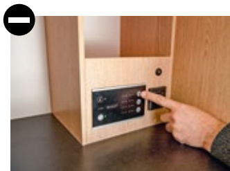
Übersichtliches Elektrik-Panel, jedoch ohne Anzeige für die Starterbatterie.
