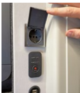
Mit zwei Aufbau-batterien und einem 600-Watt-Wechselrichter fällt die Serienausstattung üppig aus. Steckdosen: 2x USB, 2x 230 Volt.
