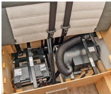
Die 95-Ah-Bordbatterie sowie die Gas-Heizung Truma Combi 6 baut Sunlight in der Sitzbanktruhe ein. Für das Foto haben wir den Truhendeckel abgeschraubt.
