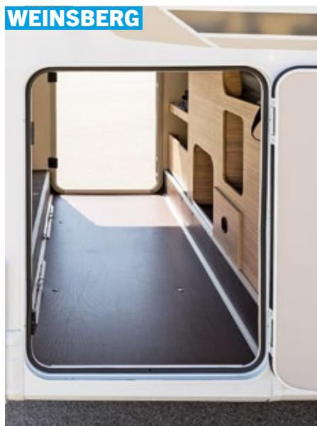
Durchladbar: Die 217 mal 114 mal 120 Zentimeter große Heckgarage lässt sich von beiden Seiten einfach beladen.
