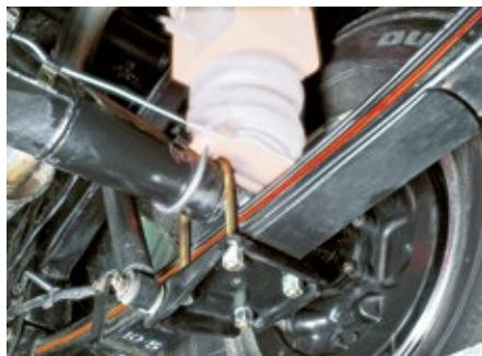
Je nach Fahrzeug werden bei einer Auflastung Teile der Federung (Spiral-/Blatt-/Zusatzzluftfeder) ergänzt.
