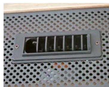
im Sitzgruppenbereich an der Küchenzeile montiert, weil dort genügend Platz vorhanden war. Die Kompressor-Kondensatoreinheit mit integriertem elektrischen Antrieb brachten die Techniker unterflur an.
