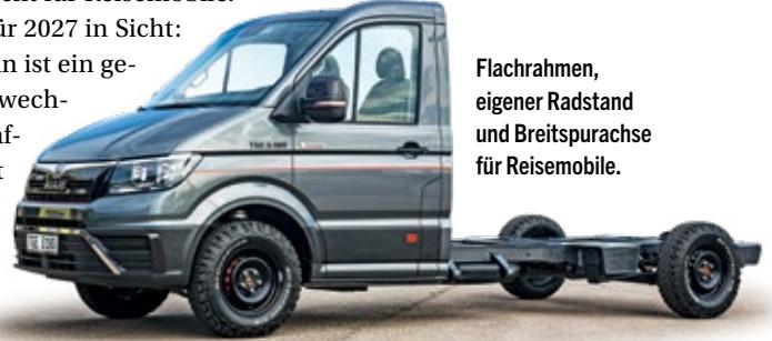
Flachrahmen, eigener Radstand und Breitspurachse für Reisemobile.
