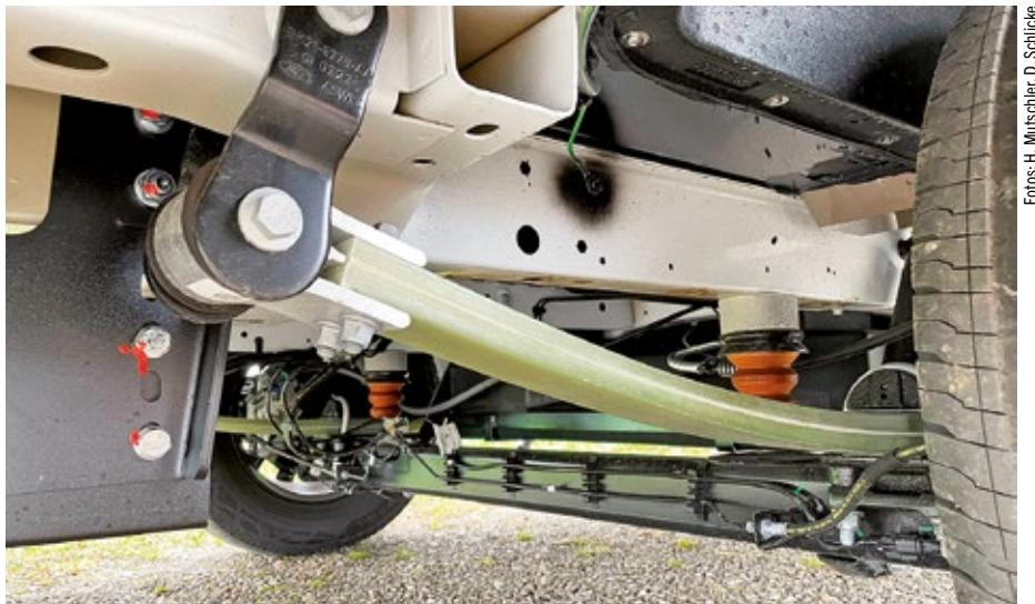
Serienmäßig beim Transit an Bord: leichte und robuste Kunststoffblattfedern an der Hinterachse.
