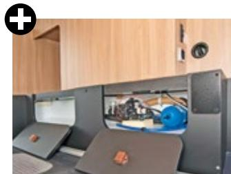
Dank dem blauen Druckspeicher läuft die Druckwasserpumpe weniger oft an.
