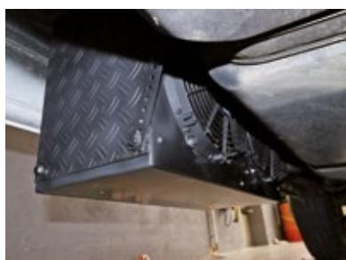
Drei Luftauslässe blasen die gekühlte Luft aus: einer im Staufach der Sitzgruppe, zwei wurden unauffällig in den Lüftungsbereich des Kühlzentrums integriert (im Foto rechts zu sehen).
