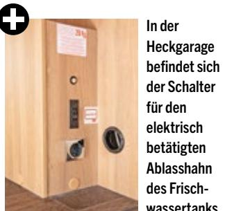
In der Heckgarage befindet sich der Schalter für den elektrisch betätigten Ablasshahn des Frischwassertanks.
