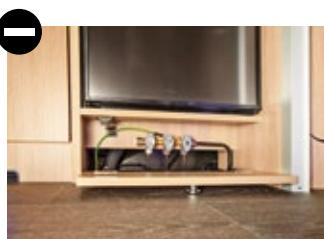
Nur per Kniestall erreichbar: die Gasabsperrhähne unterm Kühlschrank.
