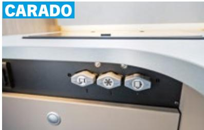
Die Gasabsperrhähne platziert Carado gut erreichbar in Hüfthöhe an der Küchenfront (links). Die separate Duschkabine lässt genug Bewegungsfreiheit zu und punktet mit zwei Abläufen – auch bei leicht schräg stehendem Fahrzeug fließt das Wasser gut ab.
