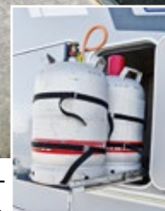
Rost an den Auszügen der Gasflaschen. Die Entlüftung benötigt dringend einen Spritzwasserschutz.
