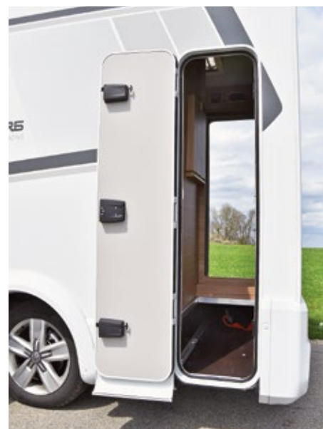
Gute Idee: Die Leiter fürs Dachbett ist in einer Halterung an der Innenseite der Schranktür klappertfrei und sicher verstaut (oben links). Der schmale Stauraum ist auch von außen zugänglich, er lässt sich mit Klappbrett unterteilen. Die Truma-Dieselheizung erreicht der Camper, wenn er im Bereich der Küche einen Bodendeckel anhebt (links).
