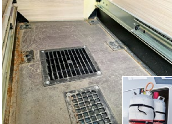
Rost an den Auszügen der Gasflaschen. Die Entlüftung benötigt dringend einen Spritzwasserschutz.
