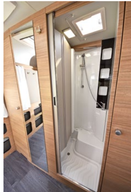
Pfiffig: Das Bad fällt zwar schmal aus, trotzdem reicht der Platz auf der Toilette und dank schwenkbarem Waschtisch entsteht eine gut nutzbare Duschkabine mit erfreulich großer Stehhöhe. Raumsparend: die Rollo-Schiebetür.
