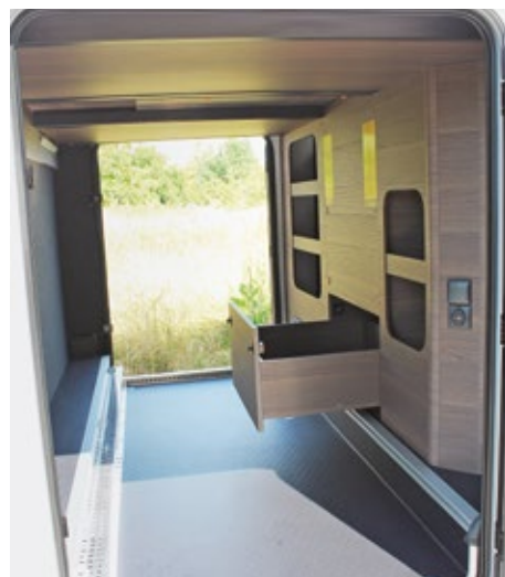
Gut gemacht: Die Einzelbetten lassen sich zur Liegewiese ausbauen, die große Garage ist beidseitig beladbar und mit Schubfach und Fächern für Werkzeug bestückt.
