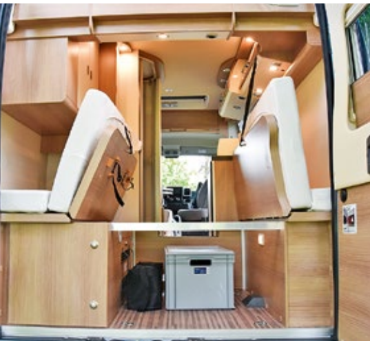
Kompromiss: Durch das tief montierte Bett fällt der Heckstauraum mit 50 Zentimetern recht flach aus.
