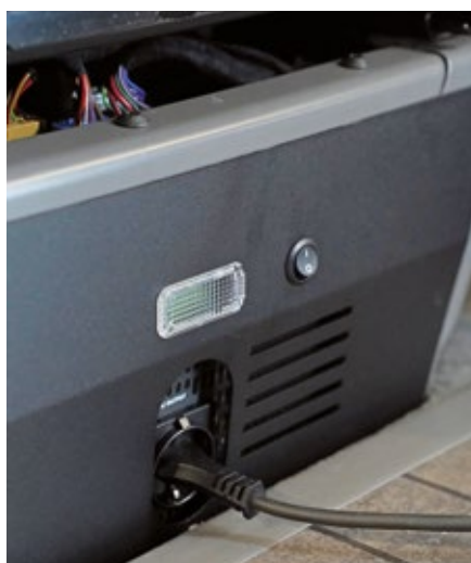
Optionaler Wechselrichter unter dem Beifahrersitz des T6.1 California.
