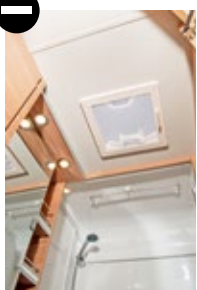
Die Dachhaube im Bad ist für schnellen Luftaustausch zu klein, zumal hier auch der Kleiderschrank steht.
