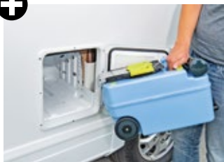
Verschalter und gewissenhaft abgedichteter Toilettenschacht.
