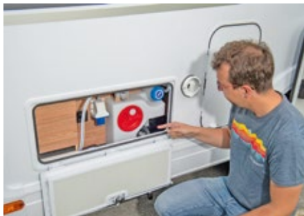
Typisch Weinsberg: das Servicefach mit Frischwassereinfüllstutzen, 230-Volt-Einspeisung und Ablassvorrichtungen für Frisch- und Abwassertank. Der Heckstauraum ist von innen und außen zugänglich.
