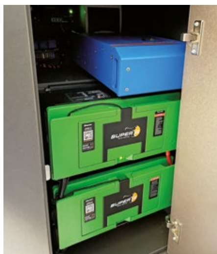
Installation im Technikschränk des Grand California mit zwei 150 Ah Epsilon und einem Wechselrichter.
