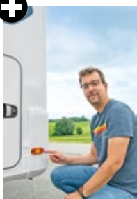
Gut platzierte Umriss- und Seitenbegrenzungsleuchten helfen im Dunkeln beim Abschätzen der Aufbauecken.
