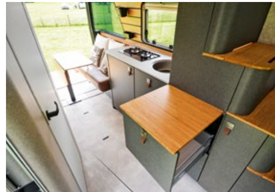
Breit und bequem: die Treppe zum Bett im Aufstelldach. Mehrere Schubfächer bieten Stauraum. Die Wandverkleidung besteht aus Kunstfaser in Filz-Optik.
