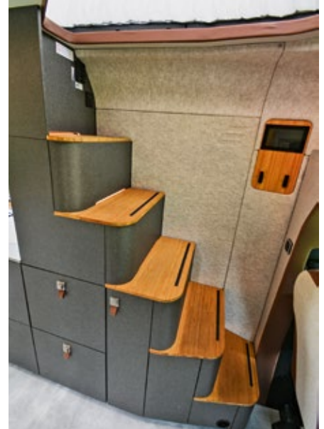
Breit und bequem: die Treppe zum Bett im Aufstelldach. Mehrere Schubfächer bieten Stauraum. Die Wandverkleidung besteht aus Kunstfaser in Filz-Optik.
