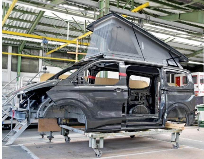
Scherensystem und Dämpfer wurden an Dach und Fahrzeug angepasst. Im Spoiler und im Rahmen sind die Antennen versteckt.
