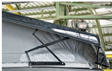
Scherensystem und Dämpfer wurden an Dach und Fahrzeug angepasst. Im Spoiler und im Rahmen sind die Antennen versteckt.
