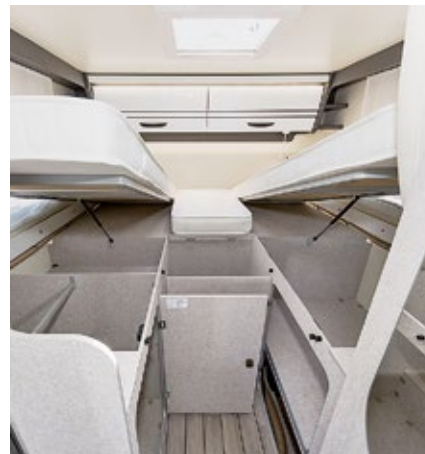
Beide Betten sind 80 Zentimeter breit, der Mittelteil wird nicht mit Lattenrost bestückt. Die Betten-Lattenroste sind beide aufstellbar, der Mittelgang breit.
