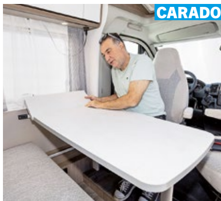
Die Tischplatte des V 337 Pro lässt sich mittels eines Einlegeteils verlängern. Dennoch ist sie für den Camper auf dem Beifahrersitz zu kurz geraten.
