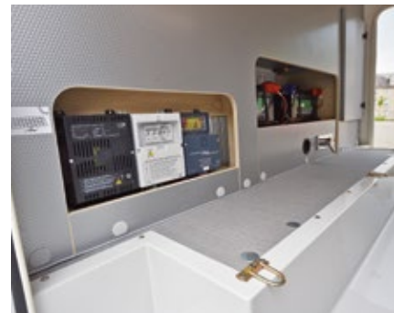
Die Bordelektrik bringt Rapido in einem offenen Fach in der zweitürigen, vollisolierten Heckgarage unter.
