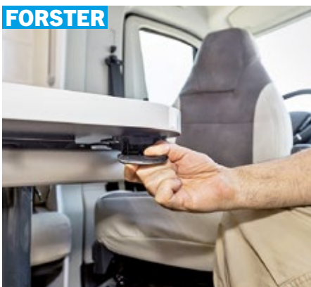
Kein Gefummel und Gebastel: Die Tischplatte lässt sich mit einem Handgriff ver- und entriegeln, um sie in alle Richtungen zu verschieben.
