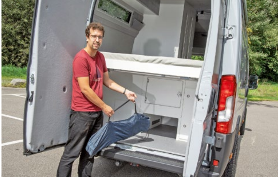
Der Heckstauraum lässt sich bis fast unters Dach erweitern, indem man das Kopfteil der Liegefläche senkrecht aufstellt. Für lange Gegenstände hat La Strada an eine Durchreiche gedacht. Rechts im Heck kommt der Gasflaschenkasten mit komfortablem Auszug unter. Nicht stark genug: die Halterung für die Hubbettleiter.
