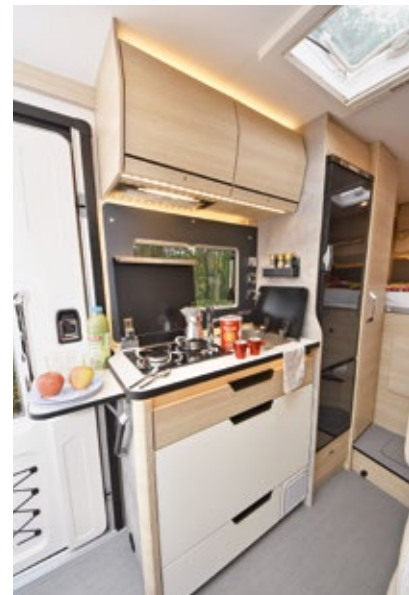
Mit elektrischem Dunstabzug und 140-Liter-Kompressorkühlschrank ist die Küche gut ausgestattet, und auch der Zweiflammherd reicht völlig aus.
