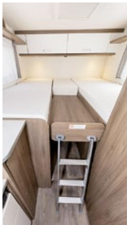
Ein Bett ist 80, das andere 70 Zentimeter breit, der ausziehbare Mittelteil kommt ohne Lattenrost aus. Die Betten-Lattenroste sind nicht aufstellbar, der Gang eng.
