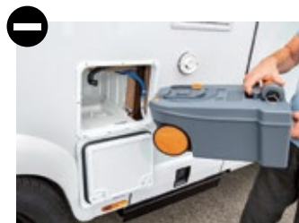
Der Toilettenschacht ist gegen auslaufende Flüssigkeit nicht abgedichtet.
