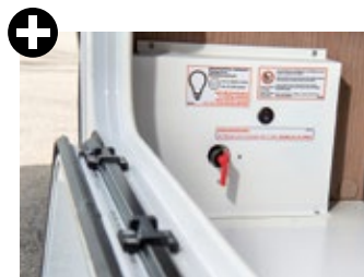
Unweit der Bordbatterie installiert Carthago den Batterie-Hauptschalter.
