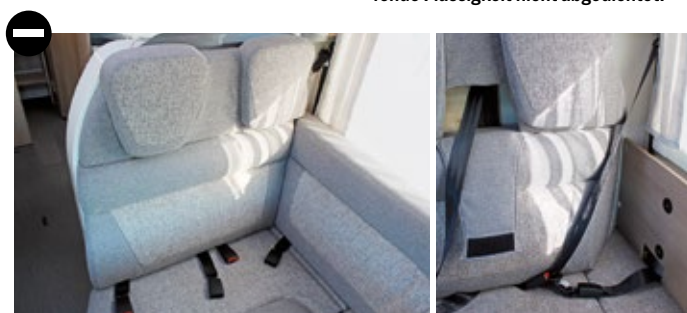
Entfernt man bei der Sitzgruppe für die Fahrt das Lehnepolster des L-Schenkels, fehlt dem in Fahrtrichtung linken Fahrgast ein Stück der Rückenlehne. Auch ist die Gurtkonstruktion unnötig kompliziert.
