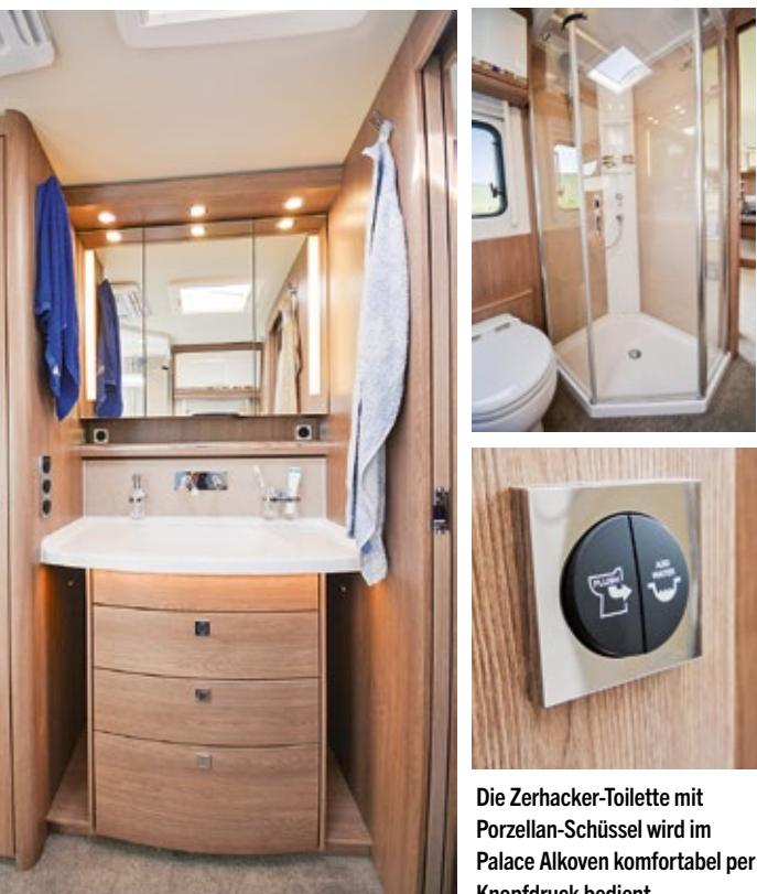
Die Zerhacker-Toilette mit Porzellan-Schüssel wird im Palace Alkoven komfortabel per Knopfdruck bedient.
