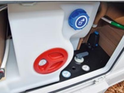
Wenn dieser Tankdeckel nicht ganz dicht ist, droht ein gewaltiger Wasserschaden. Im Zweifelsfall diesen Tank besser nur bis zur unteren Kante der Revisionsöffnung füllen.
