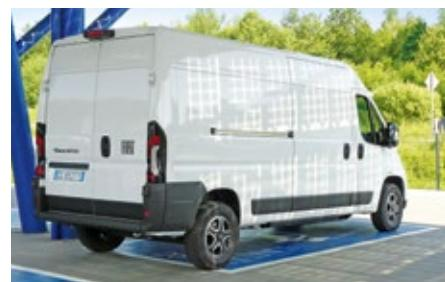
Hoch das Bein: Die stramme Parabelfeder an der Hinterachse zugunsten einer hohen Achslast hebt das Heck.
