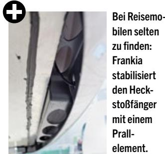
Bei Reisemobilen selten zu finden: Frankia stabilisiert den Heckstoßfänger mit einem Prall-element.
