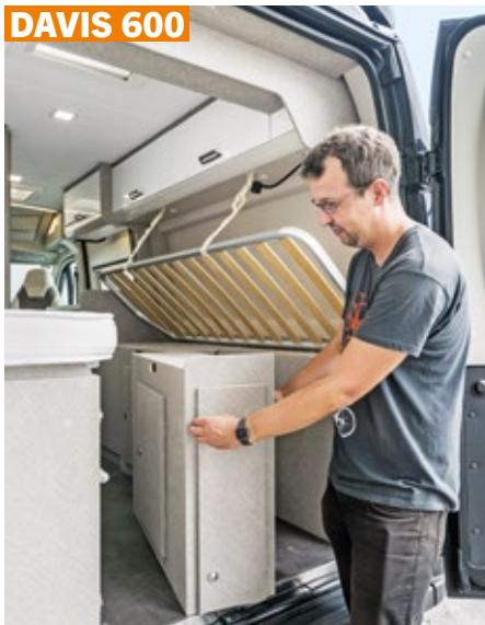
Baut der Camper die Staukästen unter einem der Einzelbetten aus, wächst die Garagenbreite auf 87 Zentimeter.
