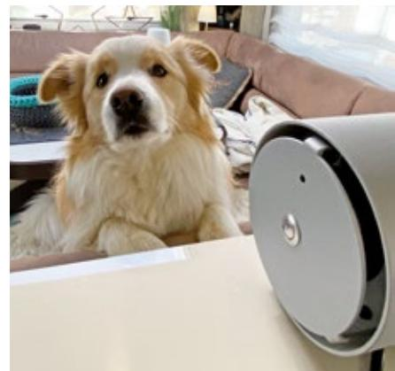
Der Ozonos-Luftreiniger (40x14x14 cm) kann stehend oder hängend montiert werden. Seine Stromversorgung gelingt via 12- oder 230 Volt.
