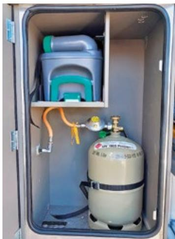
Solide und robust fällt die elektrische Trittstufe aus, die eingefahren flach am Unterboden des Van hängt und damit die Bodenfreiheit kaum verringert. In den Heck-Gasflaschenkasten integriert Hymer nun die zweite Toiletten-Kassette.
