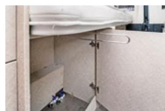
Mit ausziehbarer Kleiderstange: der Kleiderschrank unter einem der Betten.
