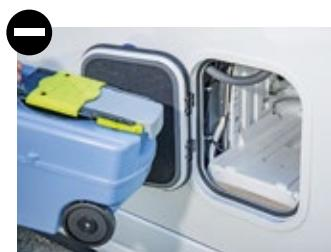
Im Testfahrzeug ist der WC-Schacht nicht abgedichtet.
