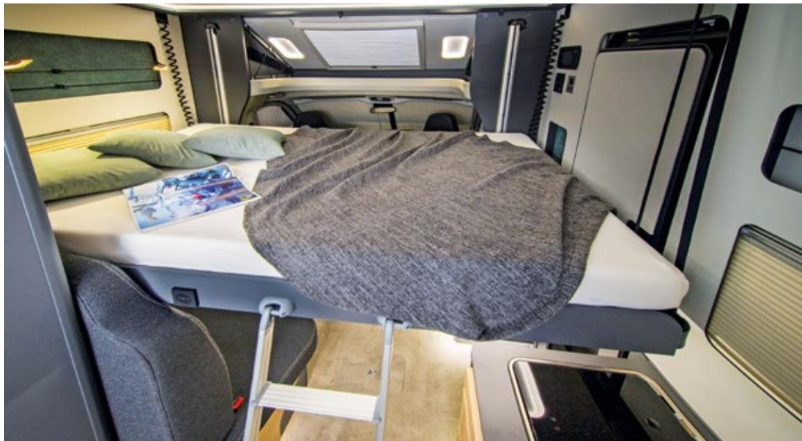
Das elektrisch angetriebene Hubbett kostet 1.590 Euro und bietet zwei weiteren Urlaubern eine Liegestatt. In zwei vertikalen Schienen geführt und an Gurten aufgehängt, ist das Hubbett wackelfrei. Zudem lässt es sich in jeder beliebigen Höhe arretieren. Die Matratze ruht auf Holzlattenrostern.
