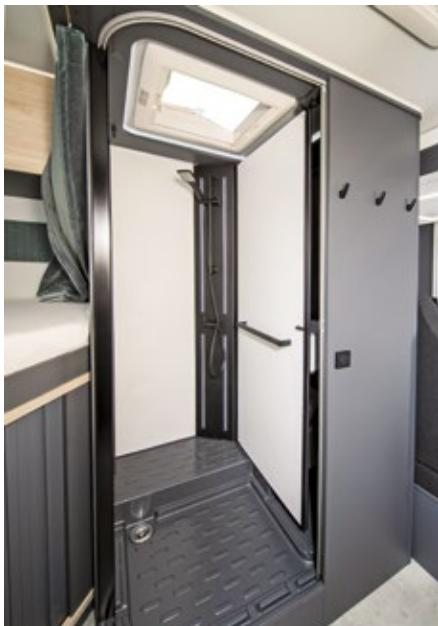
Im Bad mit raumsparender Gliedertür ist die Dusche integriert. Die Kabine zum Abbrausen entsteht, indem der Camper das Waschbecken samt Spiegelwand vor das WC schwenkt. Die dunkelgraue Duschwanne ist chic und weniger schmutzempfindlich als weiße Duschtassen. Das flache Radkastenpodest stört beim Abbrausen nicht weiter. An der optisch ansprechenden Duscharmatur fehlt eine Ablage für Duschzeug. Das Dachfenster ist groß genug für einen schnellen Luftaustausch.
