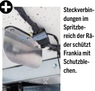
Steckverbindungen im Spritzbereich der Räder schützt Frankia mit Schutzblechern.
