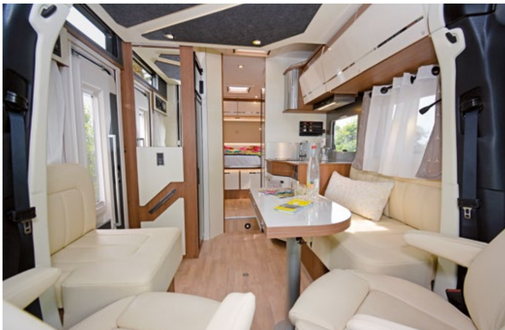
Aus Sitzbank und Einzelsitz entsteht je ein Platz für die Fahrt: hinter dem Beifah-rersitz entgegen der Fahrtrichtung, mit Beckengurt und vor dem Küchenblock in Fahrtrichtung, mit Dreipunkt-Sicher-heitsgurt und Isofix.
