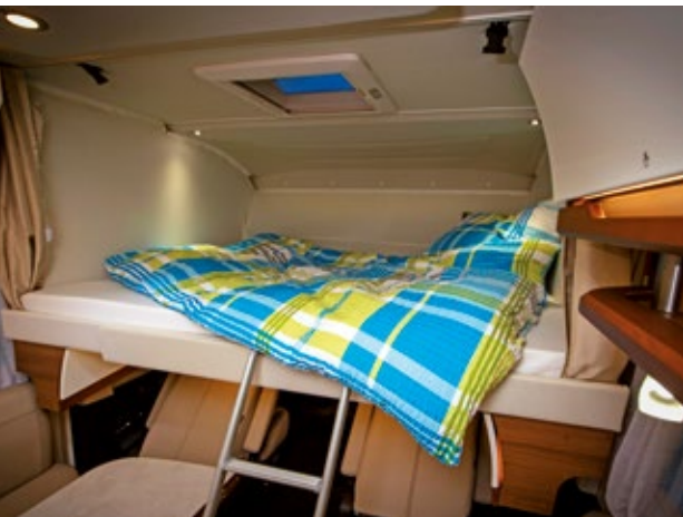
Zwischen zwei Keilen an den Seitenwänden fixiert, ist das stabile, elektrisch angetriebene Hubbett wackelfrei.
