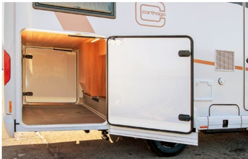
Die große zweitürige Heckgarage mit isoliertem Boden trägt bis zu 350 Kilogramm. Auf diesem Foto vom Türrahmen verdeckt, befindet sich die vorbildlich installierte Elektrikzentrale, geschützt durch ein Lochblech.
