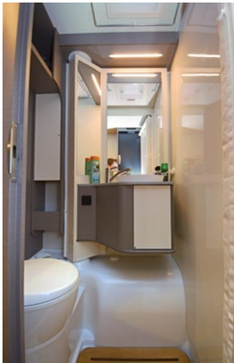
Im kompakten Bad mit integrierter Dusche schwenkt der Urlauber zum Abbrausen den Waschtisch samt Spiegelwand vor das Dreh-WC von Thetford. Das hohe Radkastenpodest dient als Ablage für Duschzeug.
