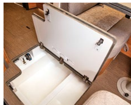
Das Bilgenfach am Einstieg reicht tief in den Doppelboden hinunter. Hier gut zugänglich: das Frostschutzventil und der Hebel zum Ablassen des Grauwassers.
