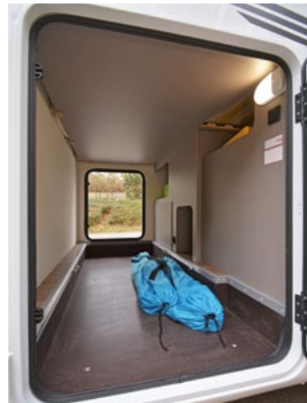
Wie bei Etrusco üblich, besteht der Garagenboden aus einer nicht isolierten Siebdruckplatte. Die Elektrik bringen die Italiener geschützt im Seitensitz unter. Gut zu erkennen: der Bock für den Umbau-Sitz. Mit schmaler Tür: der Gasflaschenkasten.
