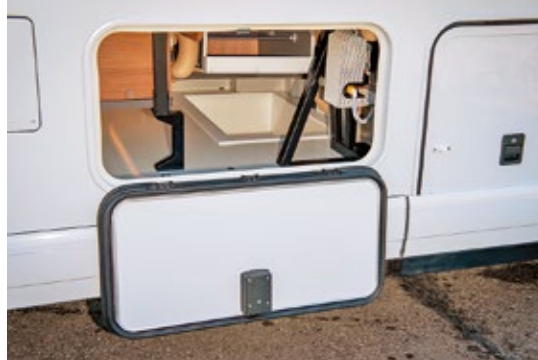
Der beheizte, isolierte Doppelboden birgt Wohnraumtechnik und zusätzlichen Stauraum. Der Gasflaschenkasten ohne störende Schwelle nimmt zwei Elf-Kilogramm-Flaschen auf.
