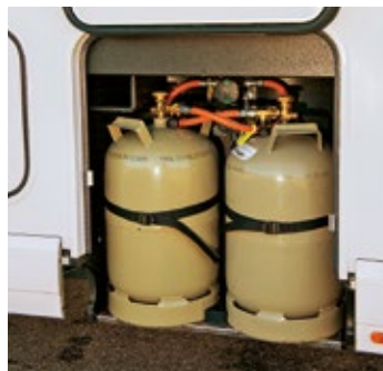
Der beheizte, isolierte Doppelboden birgt Wohnraumtechnik und zusätzlichen Stauraum. Der Gasflaschenkasten ohne störende Schwelle nimmt zwei Elf-Kilogramm-Flaschen auf.
