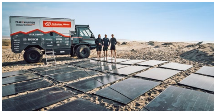
Beeindruckende Dimensionen: Das mobile Solarkraftwerk besteht aus insgesamt 28 Paneelen mit einer Fläche von 42 Quadratmetern.
