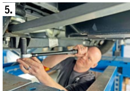
5. Die Original-Schäkel verbinden die Luftfeder mit der Achse – saubere Montage mit richtigem Drehmoment.
