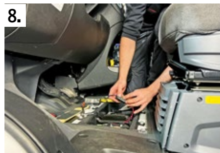
8. Keine 15 Minuten dauert es, das Kabel zur Batterie zu ziehen und die Box anzuschließen und abzusichern.
