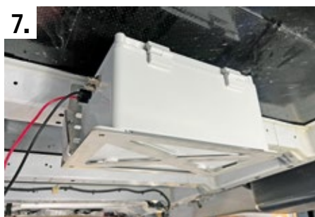
7. Stromanschlüsse und die beiden Druckluftabgänge für die Luftfedern sind oben links zu erkennen.
