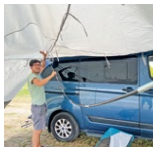
Gewusst wie: Dachverstrebung erst in die Taschen stecken und von unten nach oben ans Dach drehen.
