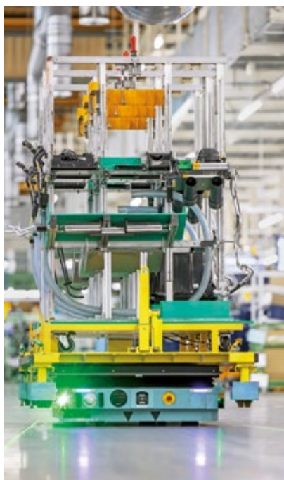
Bereitgestellt: In fahrerlosen Transportsystemen werden Teile am Band bewegt. Der Stern kommt auch an die Hecktür.
