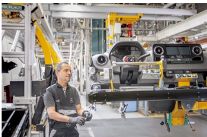
Vormontiert: Die Armaturentafel kommt fertig konfiguriert an die Stelle, an der sie in die Karosserie eingefügt wird.
