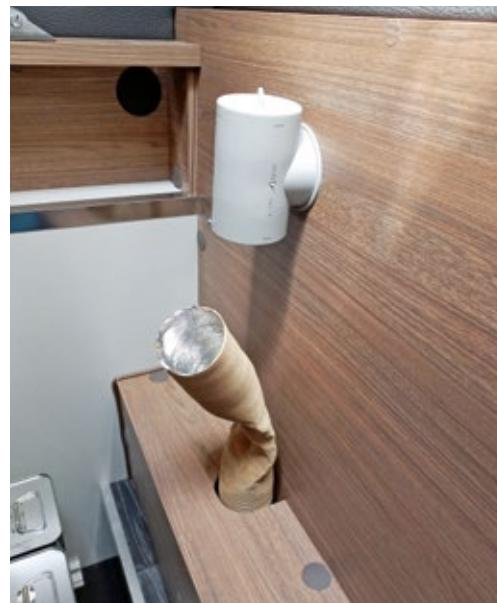
Ladung hat das ungeschützte Warmluftrohr im Heckstauraum zerdrückt. Kommt man während des Schlafs an die Leisten in den Gardinen, schlagen diese hörbar an die Aufbauwand. Wen das stört, der zieht sie einfach heraus.
