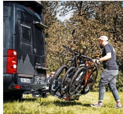
Der Strada EVO RV bietet Platz für bis zu drei Fahrräder, die auch mit breiten Reifen gut in die Radschalen passen. Er wiegt 18,4 Kilogramm.
