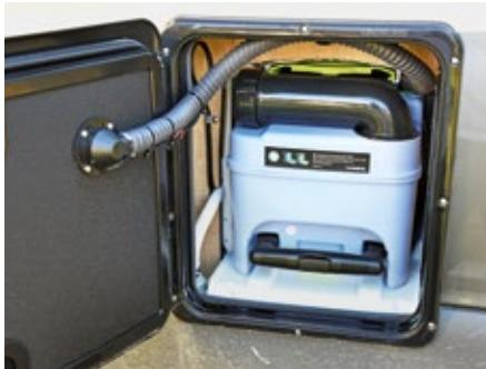
Schlauch ankoppeln und gut: Um das SOG-System muss man sich weiter nicht kümmern. Der WC-Schacht ist weitgehend abgekapselt, aber nicht abgedichtet.
