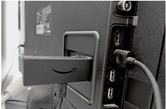
Den Fire TV Stick gibt es ab rund 45 Euro, er wird einfach in den HDMI-Anschluss des Fernsehgerätes eingesteckt und ermöglicht dann Streaming.
