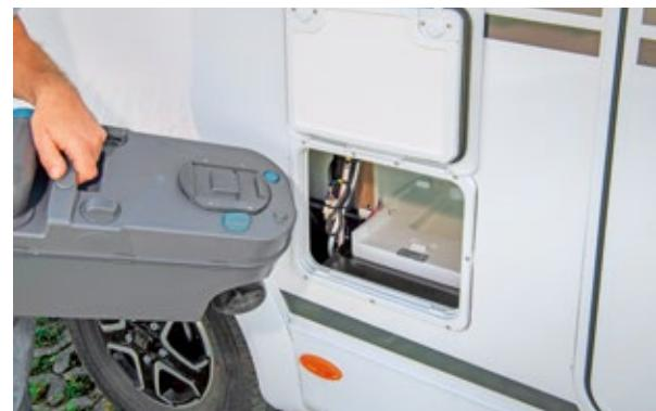
Dank pro+ ist die geräumige Heckgarage zweitürig. Ihr Boden besteht aus einer robusten, jedoch nicht isolierten Siebdruckplatte und trägt maximal 150 Kilogramm. Der WC-Schacht ist nicht abgedichtet, hat aber eine Auffangwanne unterhalb des weißen Schachts.
