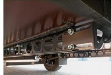
Die gelochten Längsholme der Rahmenverlängerung unter der Heckgarage sind an ihren Enden schön gerundet, was die Verletzungsgefahr minimiert. Die Gasregler von GOK mit Crashsensoren lassen sich mit wenig Aufwand auch nachträglich installieren.
