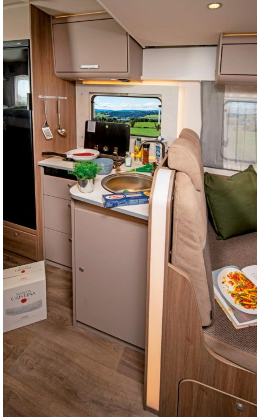
Die Küche stattet Carado mit elektrisch zündendem Zweiflammherd und großer Rundspüle aus. Der Absorberkühlschrank von Thetford mit integriertem Eisfach fasst 137 Liter: genügend für eine Familie. Die Arbeitsplatte ist gewissenhaft abgedichtet.
