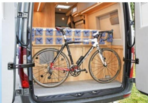
Ohne den zusätzlichen Schrank, der zur Ausstattung ab Werk gehört, misst die Heckgarage 177 x 72 x 59 cm. Der Schrank kann mit Flügelmuttern flugs ein- oder ausgebaut werden.
