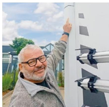
**„Typisch Carado: Der Aufbau ist einfach gestaltet aber sehr gut verarbeitet. Noch besser aber wäre es, die Anbauteile aus Kunststoff mit Kedern zu unterlegen, damit sie nicht scheuern können.“**
