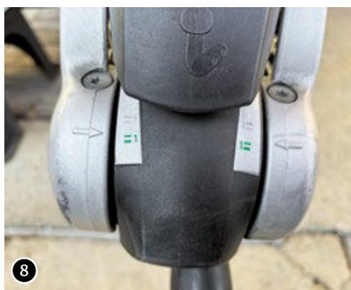
Schnell vernachlässigt, im Ernstfall aber ein Problem: Die Verbindung von Auto und Caravan. Die Kupplungen zeigen Verschleiß für alle relevanten Teile an.
